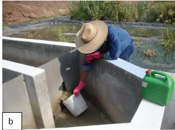
Foto 4.1 a) Caudal de llegada al sistema y b) caudal de operación medido en el vertedor sutro a la salida del desarenador
