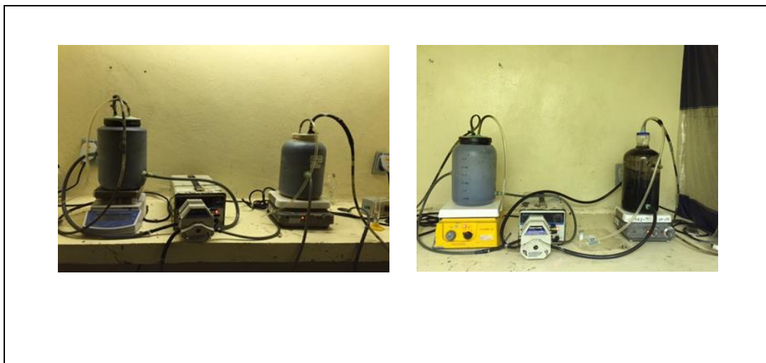
Figura 2.26 Módulo experimental de estabilización anaerobia.
