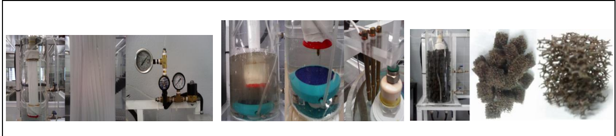
Figura 2.9 BRM, sistema de presión transmembrana, aereadores y empaque.
