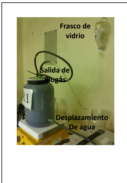
Figura 2.23 Prueba de desplazamiento de biogás.
