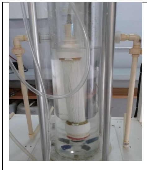
Figura 2.3 Fotografía del BRM con agua desionizada.
