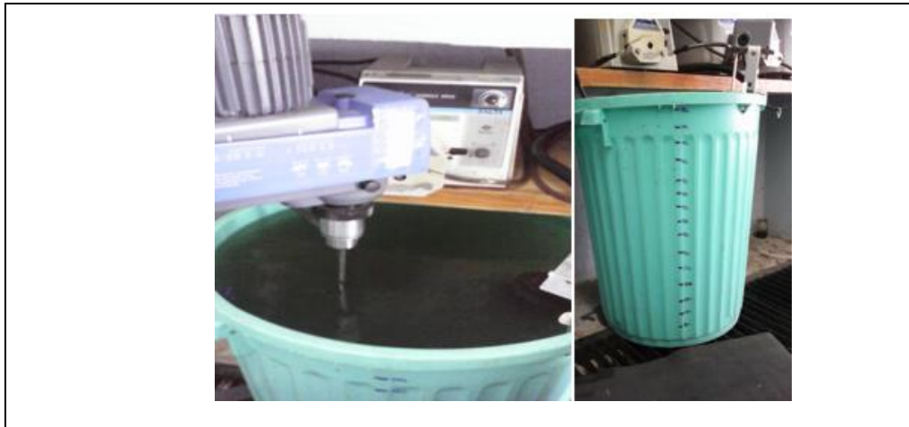
Figura 2.10 Agua residual municipal para alimentación del sistema.
