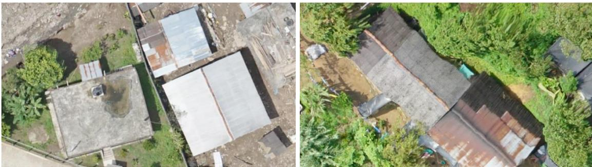
Figura 5.20. Diferentes niveles de distorsión en un ortomosaico debido al grado de traslape entre imágenes, Zona central del ortomosaico con alto grado de traslape y distorsión ligera (izquierda), Zona periférica del ortomosaico con bajo traslape y alta distorsión (derecha).
