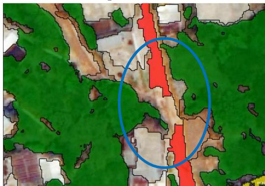
Figura 6.20. Errores en la clasificación del pavimento (imagen satelital).
