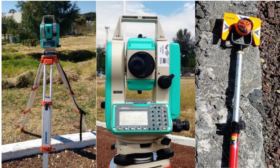
Figura 3.16. Trípode, estación total Nikon y prisma
