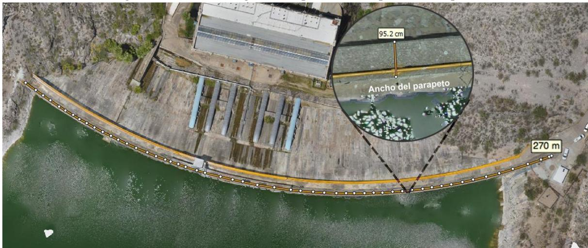
Figura 7.12. Medida de la longitud de la cortina y el ancho del parapeto
