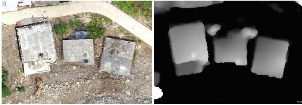
Figura 6.31. Raster de diferencia de altura entre el MDS y MDT
