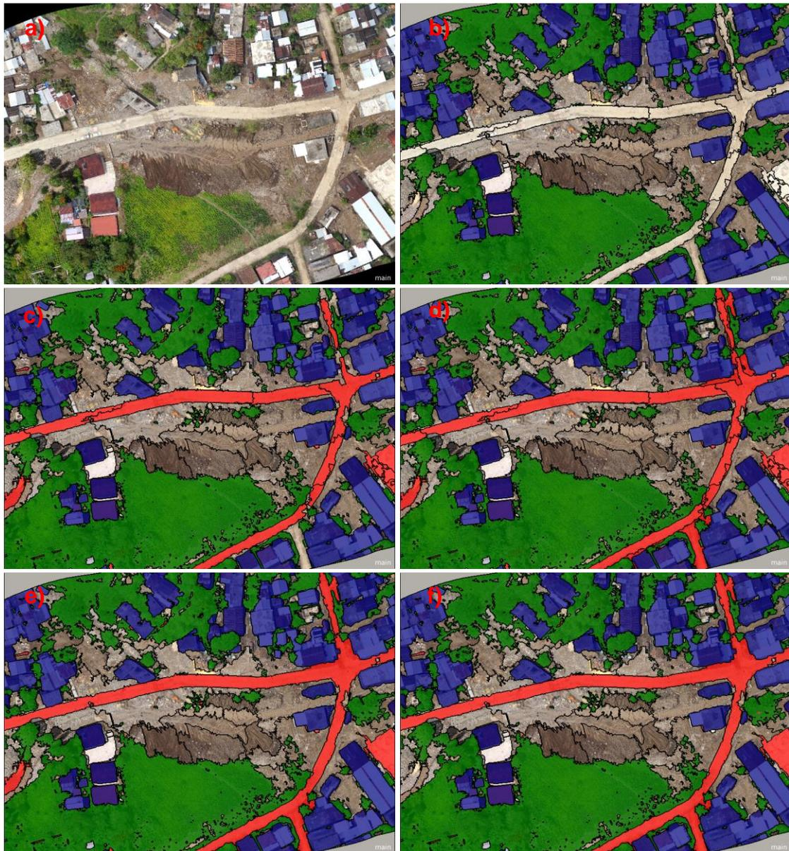
Figura 6.35. Etapas de la clasificación de las carreteras de concreto: a) imagen falso color b) segmentación, c) clasificación según la banda azul ( $>139$ ), d) relación borde con segmentos vecinos, e) unión de segmentos, f) eliminar objetos pequeños.
