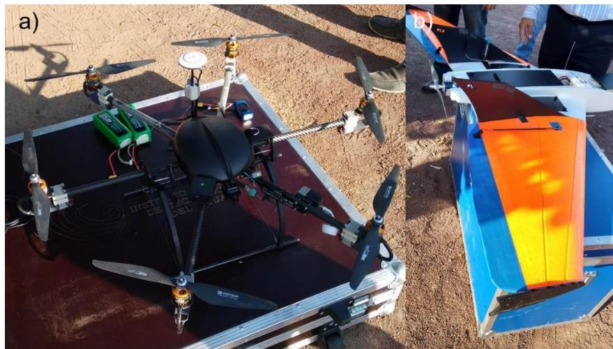
Figura 3.1. Tipos de VANTs a) Multirotor y b) de ala fija
