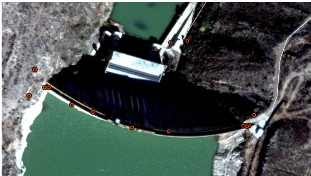
Figura 7.5. Ubicación de puntos de control en la cortina de la presa La Boquilla
