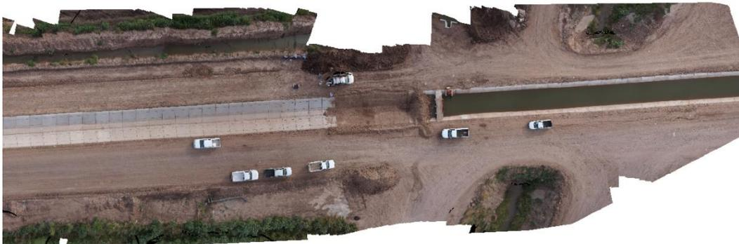
Figura 3.13. Ortomosaico de un canal del DR075 generado con información de un VANT
