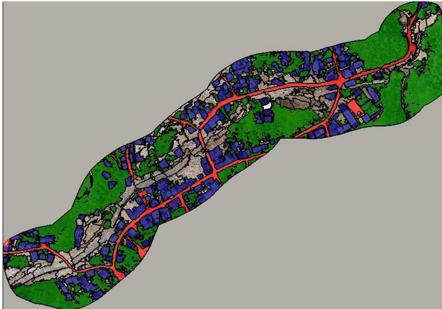
Figura 6.36. Clasificación del pavimento (ortomosaico).
