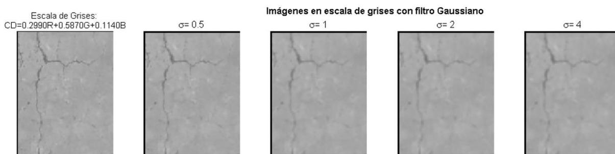
Figura 7.17. Filtro Gaussiano con distintos parámetros de escala
