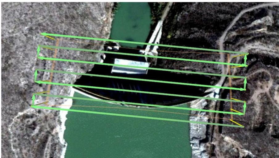
Figura 7.6. Misión de vuelo sobre la presa la boquilla
