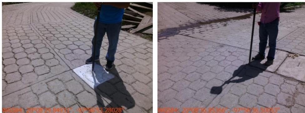
Figura 5.9. Marcas de puntos de control (izquierda) y verificación (derecha)
