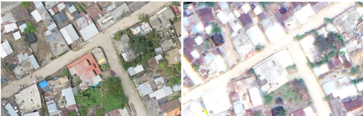
Figura 3.7. Resolución espacial de dos imágenes obtenidas con dos vehículos a) 5 cm (con VANT) y b) 30 cm (Satelital).
