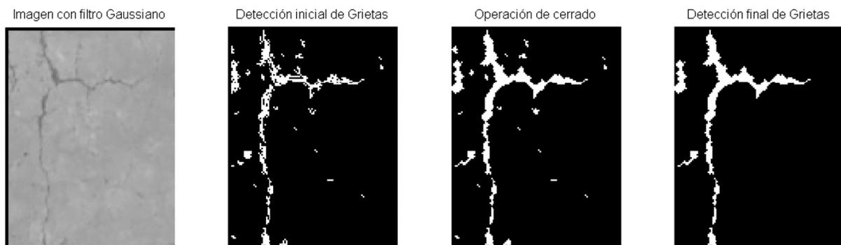
Figura 7.22. Grietas basadas en detección de líneas
