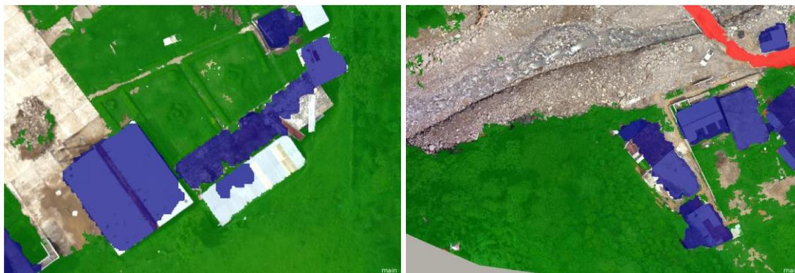
Figura 6.34. Detalle: Errores en la clase construcciones (ortomosaico).
