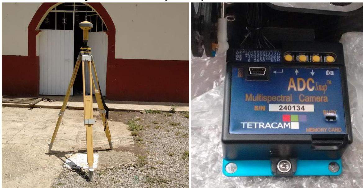
Figura 4.2. GPS RTK (izquierda), Cámara Multiespectral Tetracam (derecha).
