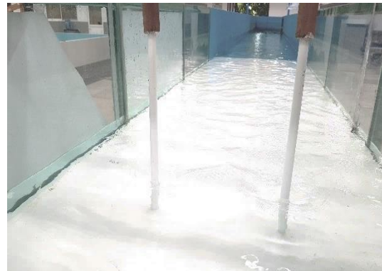
Canal experimental y modelo de pilas de puente.
