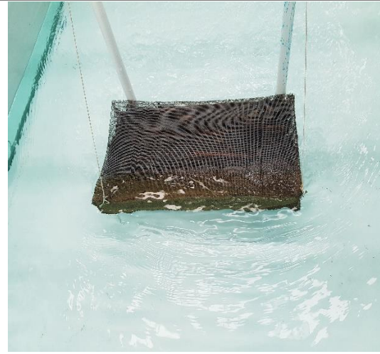
Canal experimental y modelo de pilas de puente con acumulación de material.
