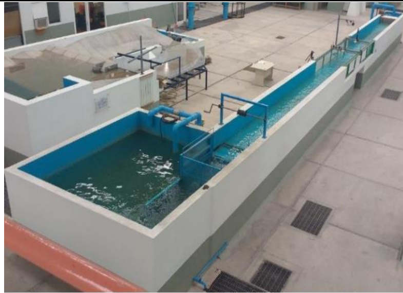
Figura 36. Canal de pendiente nula en funcionamiento. Fuente: (Peñaloza Rueda et al. , 2015).
