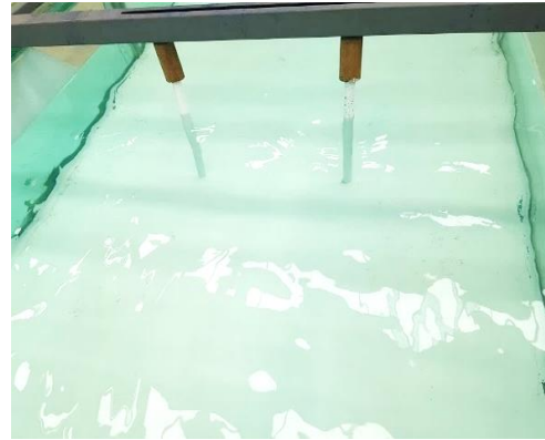
Canal experimental y modelo de pilas de puente.
