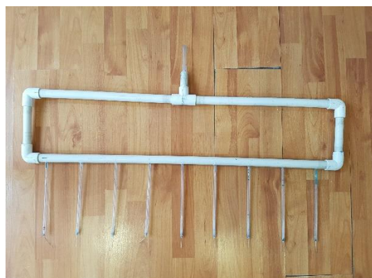
(A) Mecanismo de inyección de tinta.
