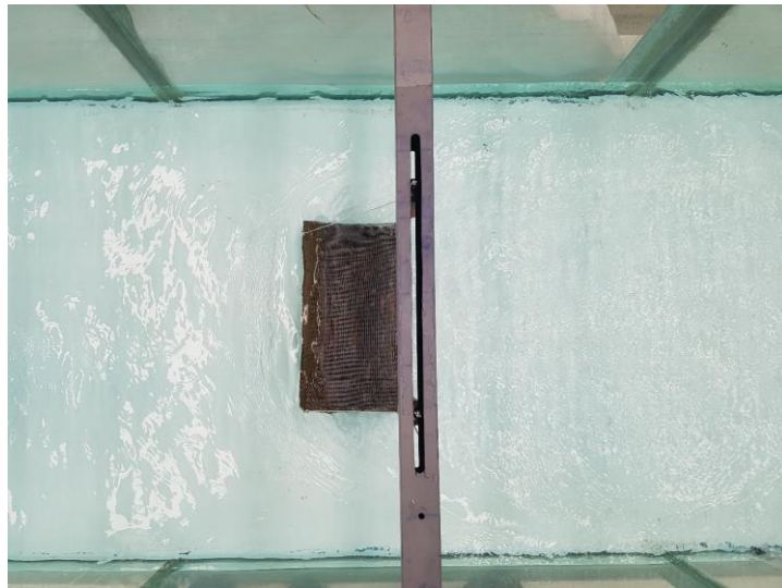
Figura 55. Forma de acumulación instalada y flujo circulando.
