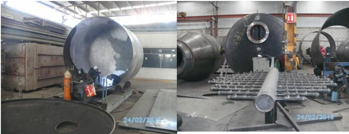
**Figura 13. Fabricación de tanques de acero para filtros en taller de pailería**
