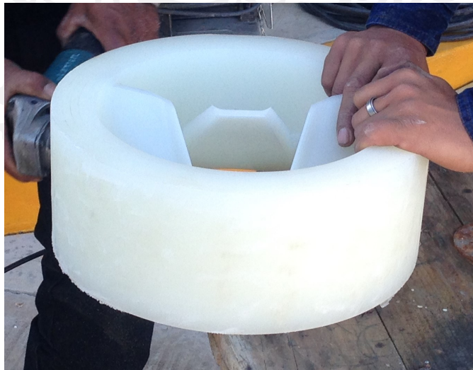
Figura 7. Placa para inducción de turbulencia.
