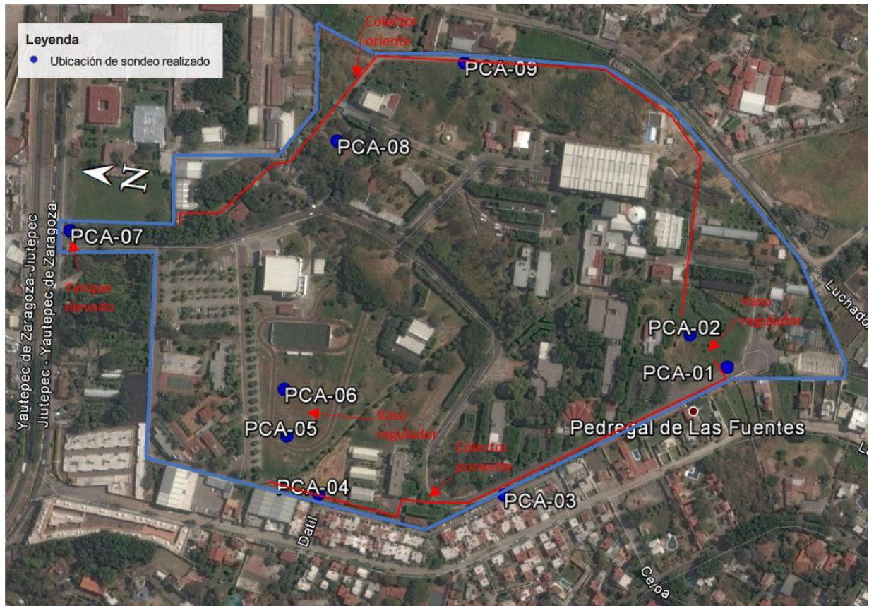
Ilustración 7.29 Ubicación de los sondeos realizados
