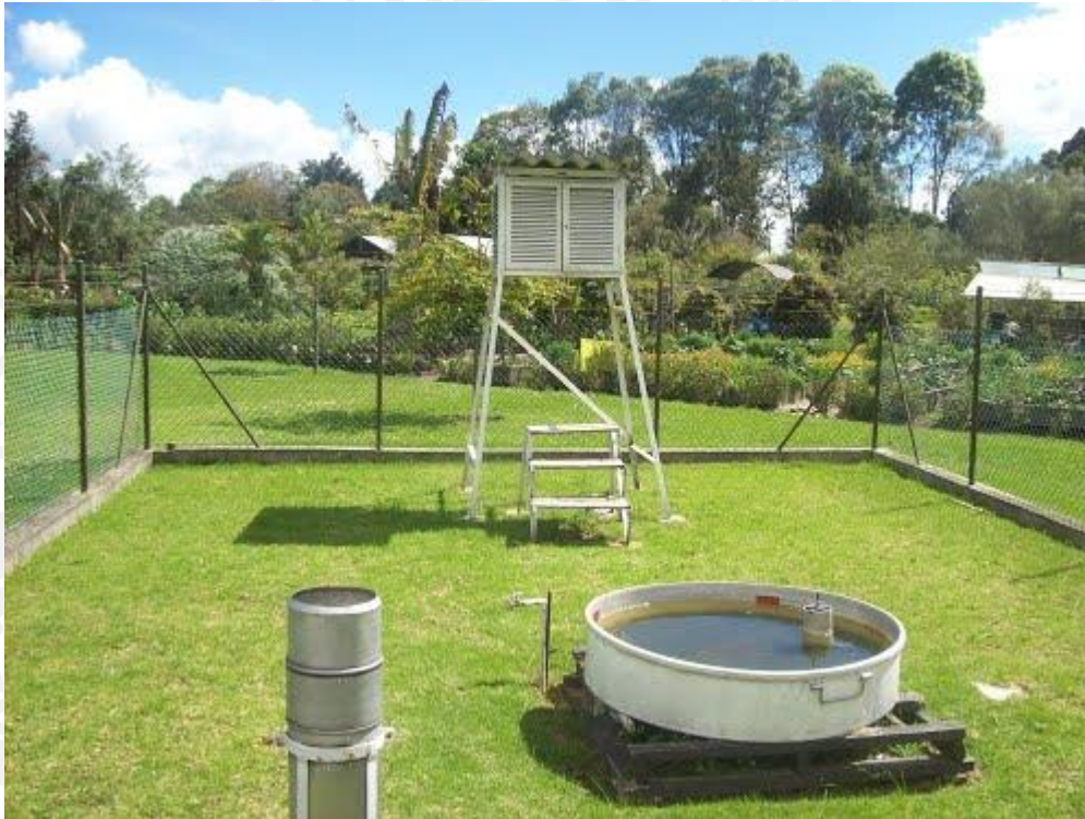
Figura 3 Estación climatológica tradicional y su equipamiento básico
