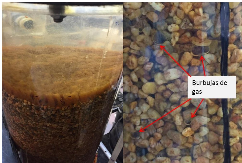
Figura 3-7. Aspecto del floculador granular. Izq. Se observa una cama de lodos en la parte superior del filtro. Der. Se alcanzan a apreciar burbujas de gas provenientes de la electrocoagulación atrapadas entre las partículas del filtro.
