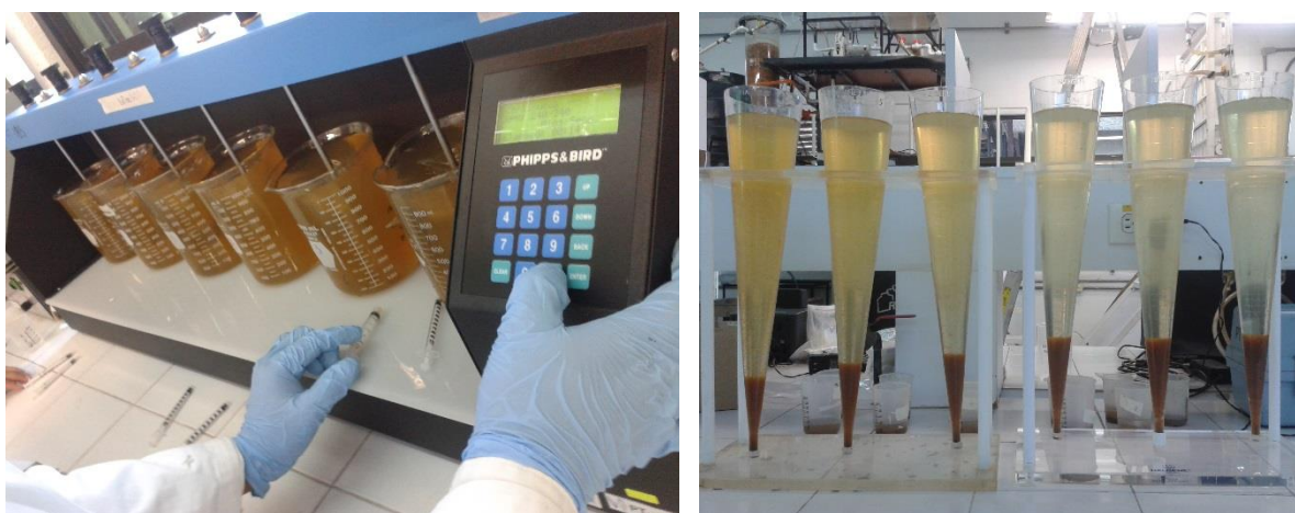
Figura 4-2. Mezcla rápida y sedimentación de lodo en conos Imhoff.
