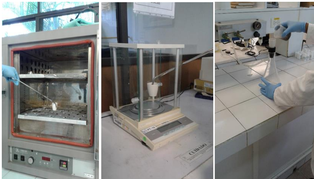
Figura 4-6 Imágenes de determinación de sólidos suspendidos totales.
