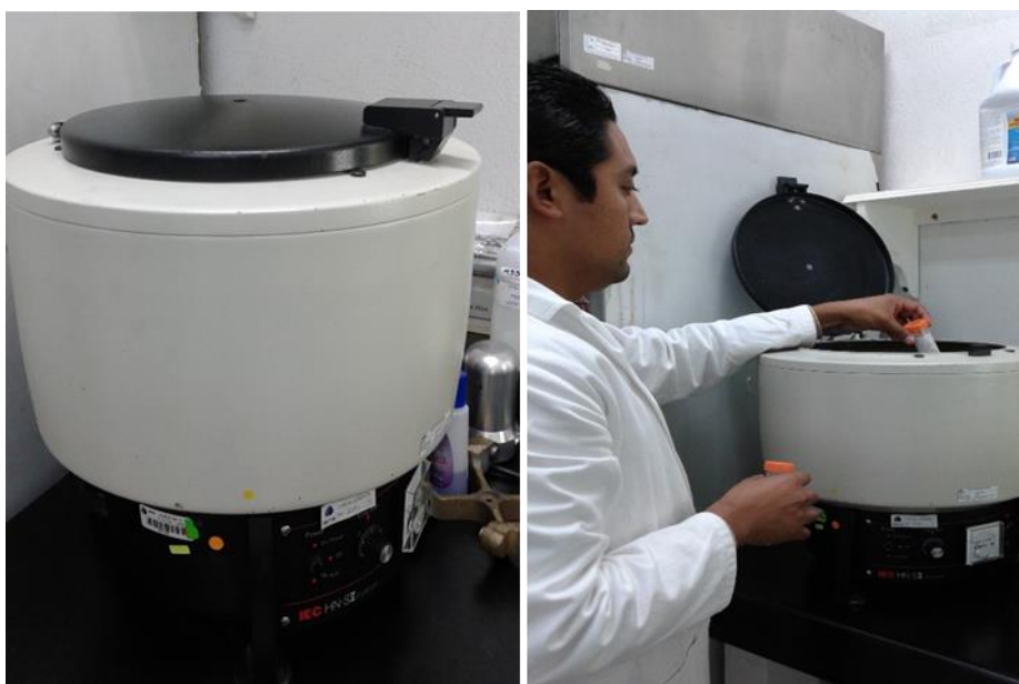
Figura 4-5 Centrifugación de lodos.
