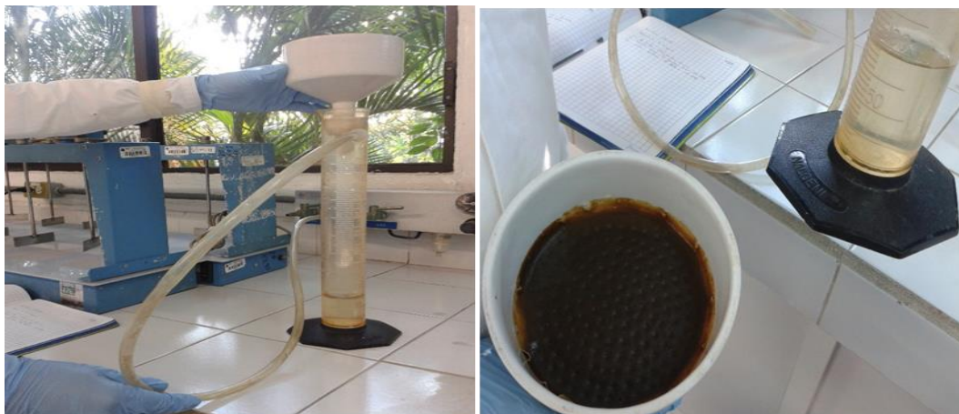
Figura 4-3 Experimento para determinar el tiempo a la filtración del residuo espesado.
