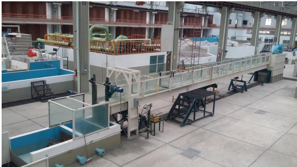
Foto 17. Panorámica del canal de pendiente variable, de 18 m de longitud, sección de 0.60 m X 0.685 m. Se observa el sistema de control de la pendiente con cilindros hidráulicos y bomba manual. Asimismo el control electromecánico para posicionar placa vertedora en el extremo final del canal.
