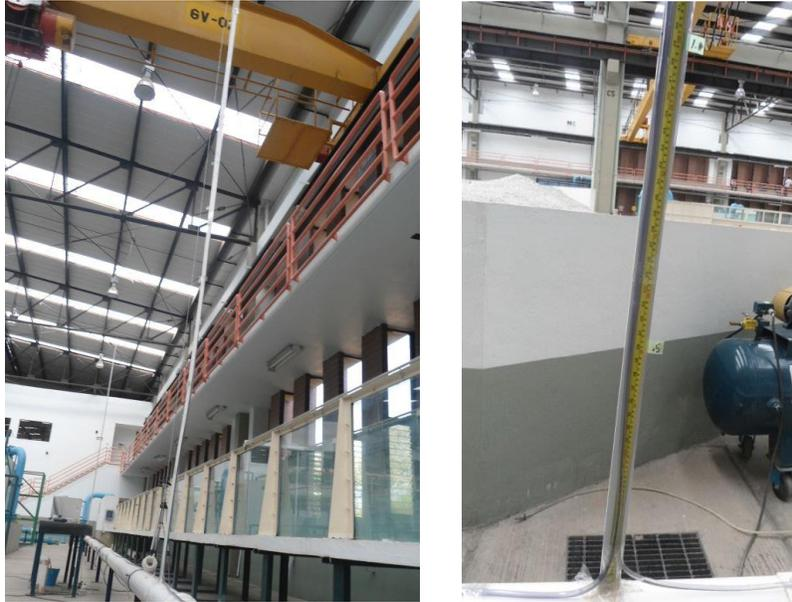
Fotos 43 y 44. Piezómetros de manguera
