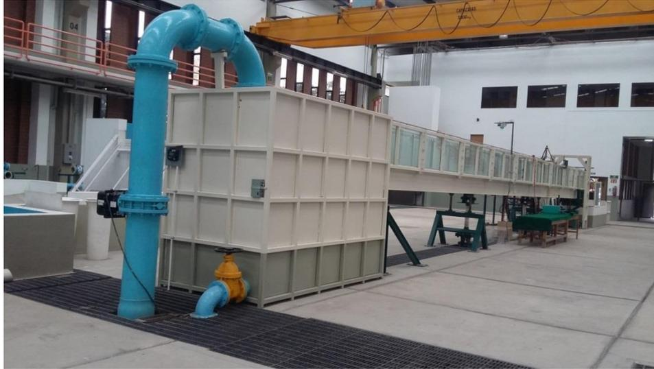
Foto 18. Canal de pendiente variable de 18 m de longitud. Detalle de alimentación del canal de pendiente variable. Se observa una servo-válvula para control de flujo. Asimismo el elemento secundario de un medidor electromagnético.
