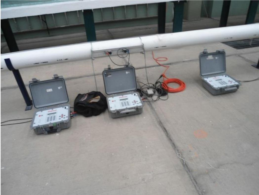
Foto 42 . Medición de gastos con tres equipos ultrasónicos Thermo Scientific
