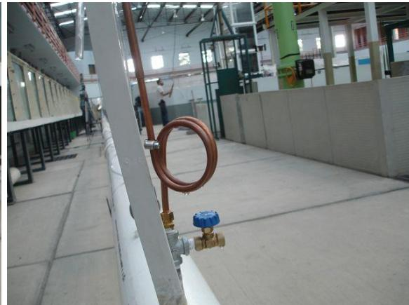
Fotos 28 y 29. Piezómetros con vuelta de tubo para reducir fluctuaciones en los piezómetros
