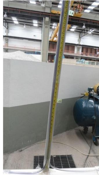
Fotos 26 y 27. Piezómetros de manguera
