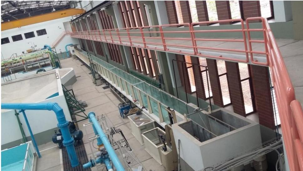
Foto. 15. Canal largo de pendiente nula del IMTALAB. Longitud: 48 m, y sección de 0.61 m X 0.99 m.
