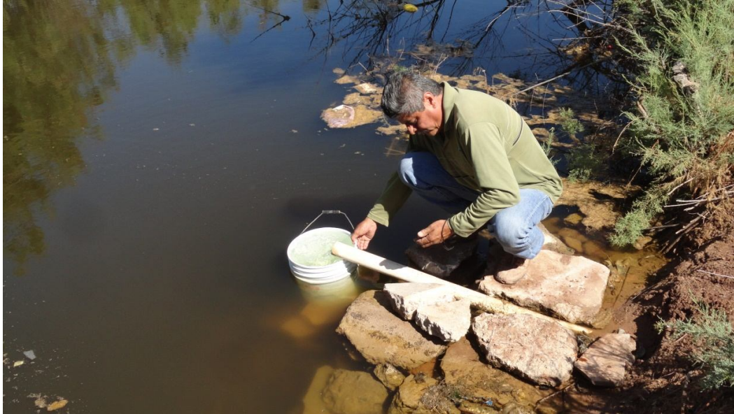
Ilustración 8. Aforo del gasto bombeado por el molino de viento.
