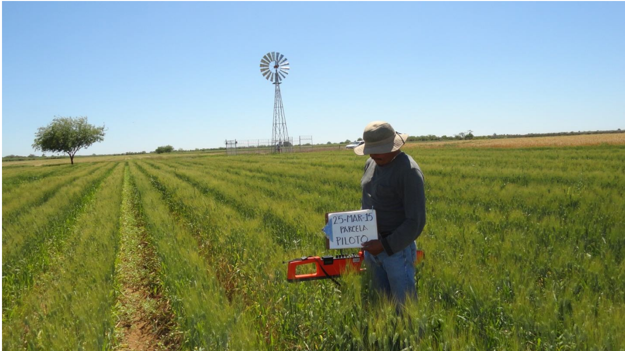
Ilustración 5. Estimación de la salinidad con un sensor electromagnético EM-38 en la parcela piloto
