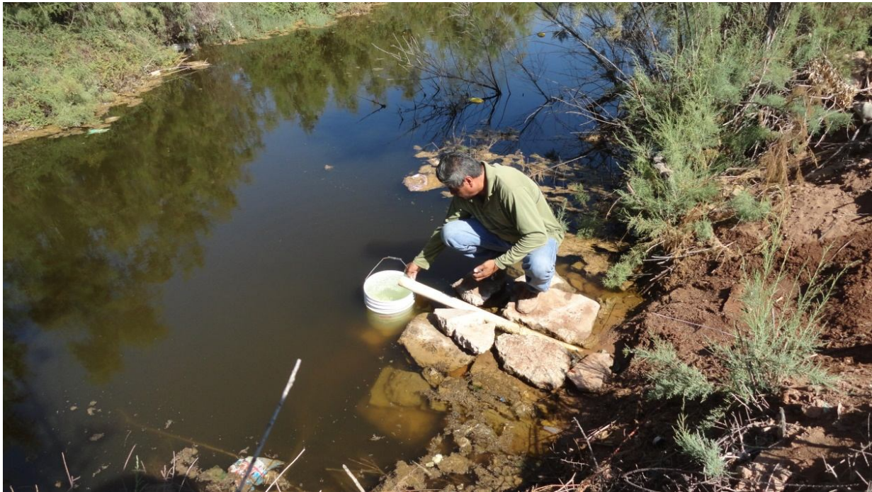
Ilustración 38. Aforo del agua bombeada por el molino de viento
