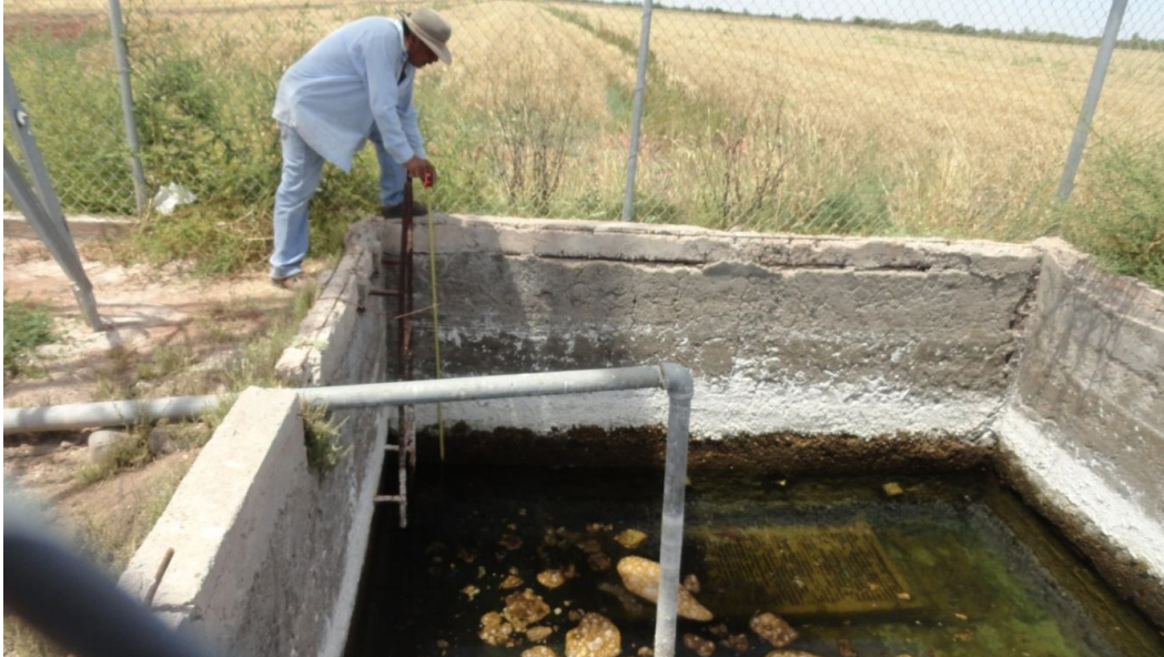
Ilustración 33. Medición del nivel freático en el cárcamo de bombeo de la parcela piloto de drenaje con energía eólica.
