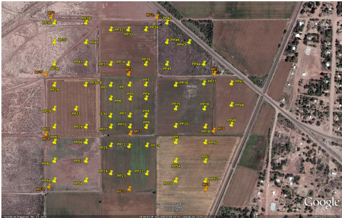
Ilustración 3 Distribución de sitios para la monitorización de la salinidad del suelo, y de pozos para medir el nivel freático, en una parcela piloto de drenaje con energía eólica y su área de influencia.
