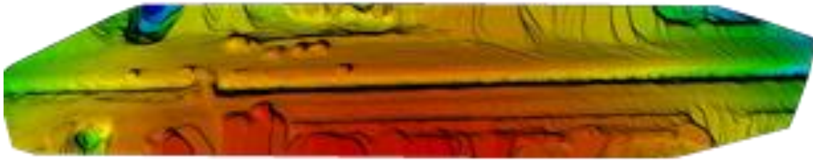
Figura 8.4 Mosaico y Modelo digital del terreno de un canal de riego obtenido mediante el uso de cámaras instaladas en un VANT.
