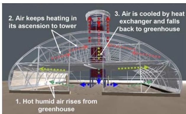
Ilustración 54. Esquema de un novedoso sistema húmedo aire-colector solar para la horticultura de invernadero.
