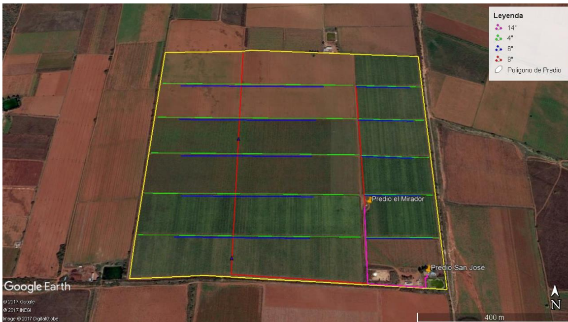
Figura 4.10. Ubicación del equipo de bombeo y su red de distribución (Predio San José)
