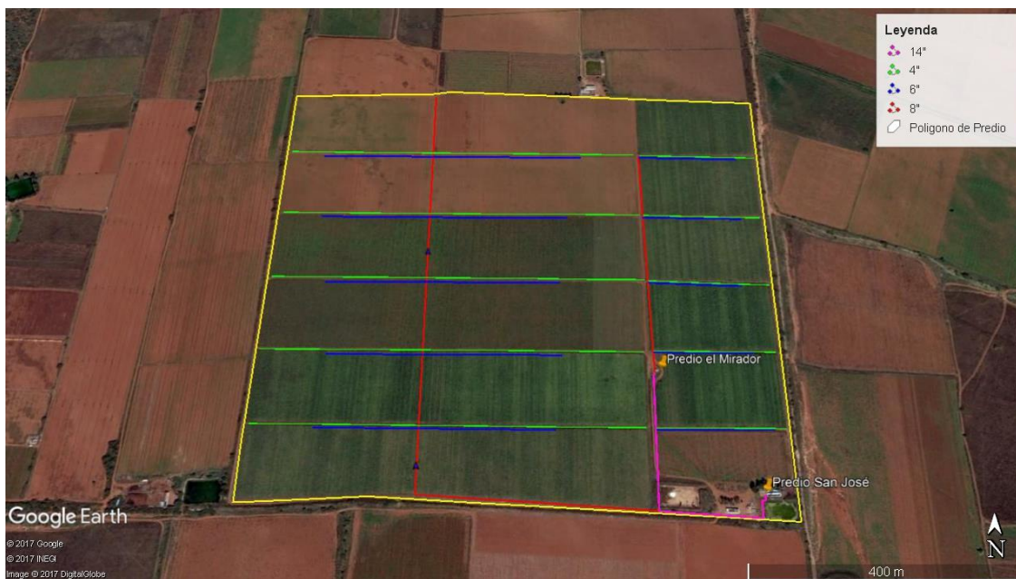
Figura 4.8. Ubicación del equipo de bombeo y su red de distribución (Predio el Mirador)
