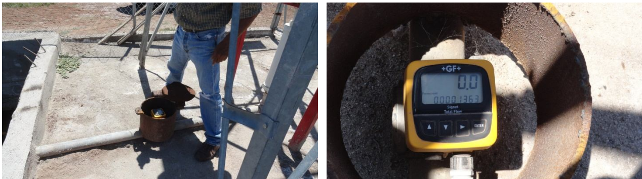
Ilustración 4. Medidor volumétrico utilizado para registrar el volumen de bombeo.
