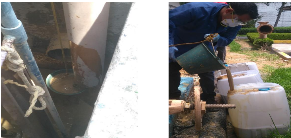
Figura 5.3-3. Toma de muestra lodos (Madín)
