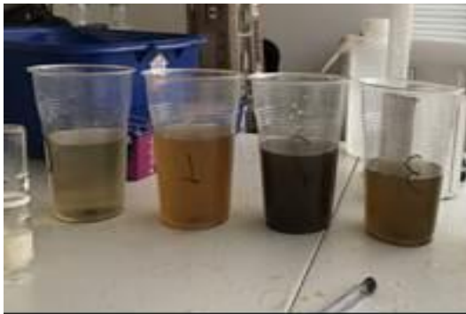
Figura 5.3-15. Muestras de retrolavado de filtros (Alamito). Izq. a derecha minutos 0-7
