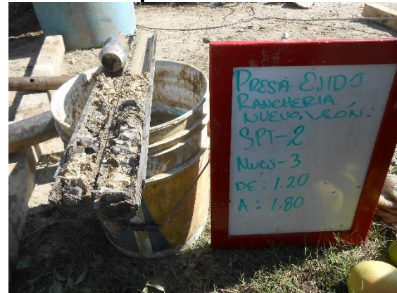
Fotografía III.31 Muestra de suelo recuperada del SPT-2.
