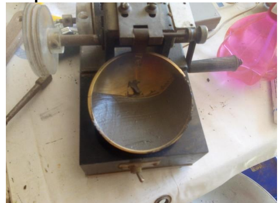
Fotografía III.37 Prueba de límite líquido en copa de Casagrande.
