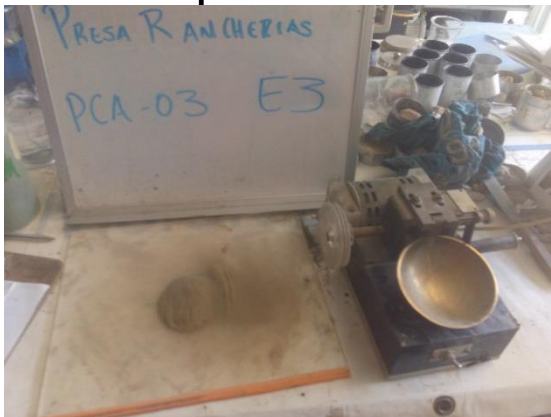
Fotografía III.36 Material para prueba de límite líquido en copa de Casagrande.
