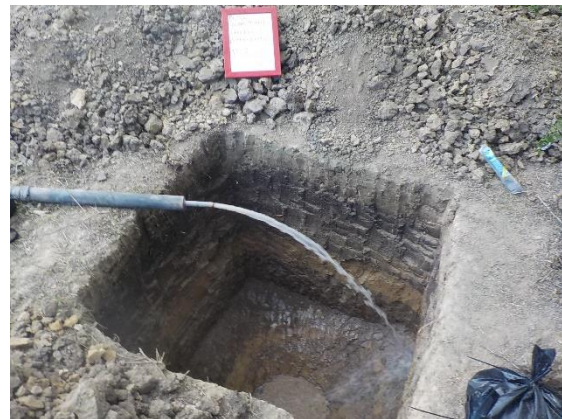
Fotografía III.25 Prueba de permeabilidad en el PCA-5.
