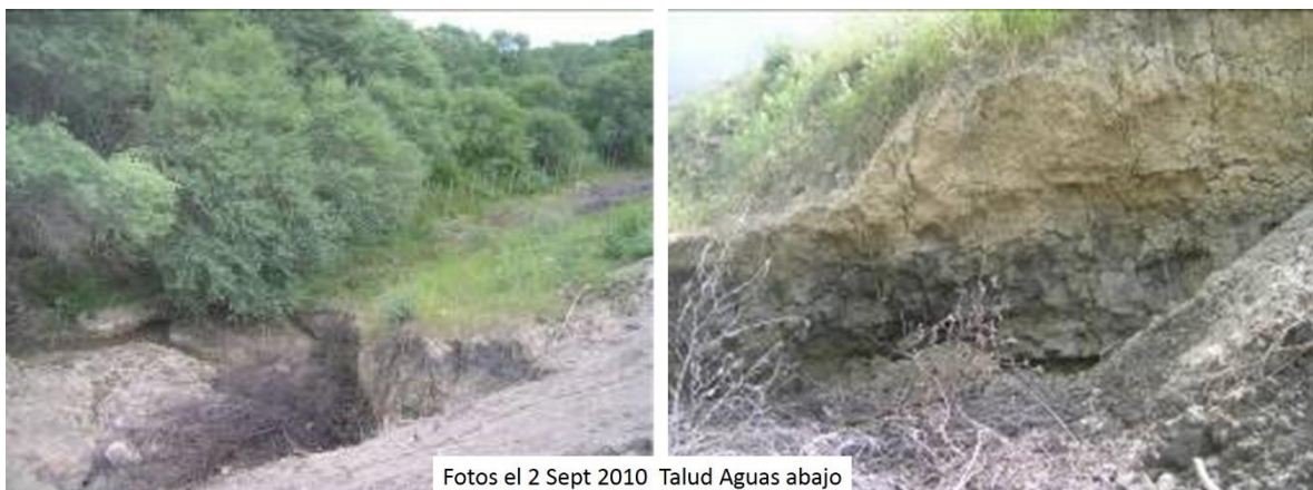
Fotografía VI.10 Vistas de la cárcava desde la corona hacia el pie del talud (izq) y del escarpe (derecha).
