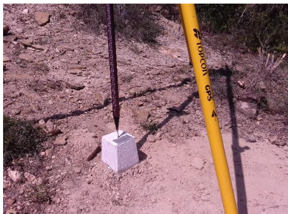
Fotografía III.2 Vértice de referencia GPS1 en el extremo izquierdo de la presa Rancherías.
