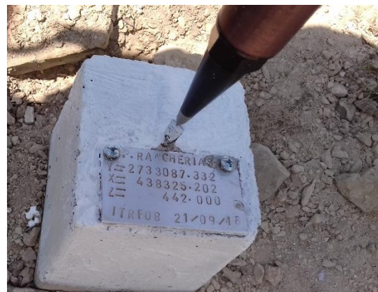
Fotografía III.3 Coordenadas del vértice de referencia GPS1 en la presa Rancherías.
