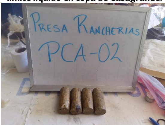
Fotografía III.38 Probetas para prueba de compresión triaxial.
