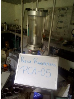
Fotografía III.40 Prueba de compresión triaxial.
