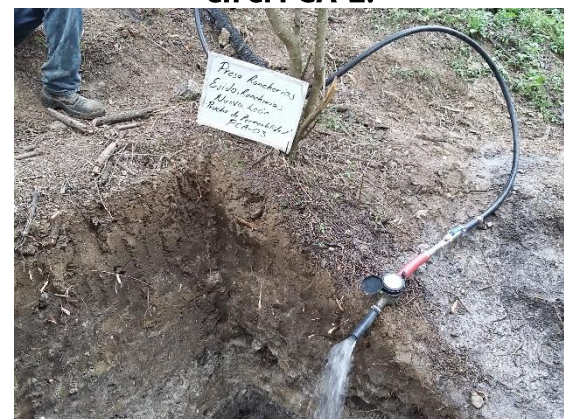
Fotografía III.21 Prueba de permeabilidad en el PCA-3.
