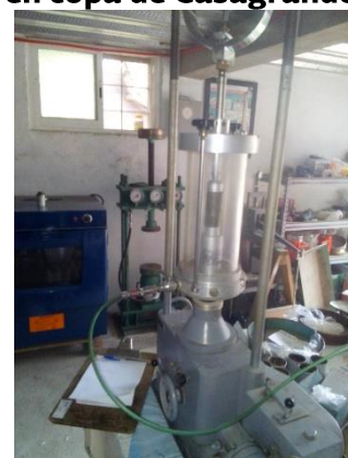
Fotografía III.39 Prueba de compresión simple.
