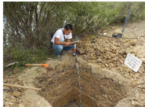
Fotografía III.19 Prueba de permeabilidad en el PCA-2.
