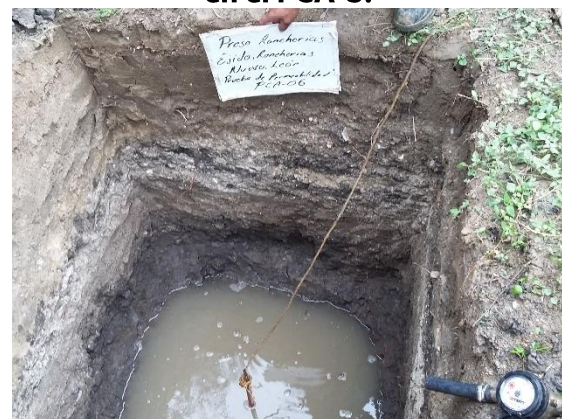
Fotografía III.27 Prueba de permeabilidad en el PCA-6.
