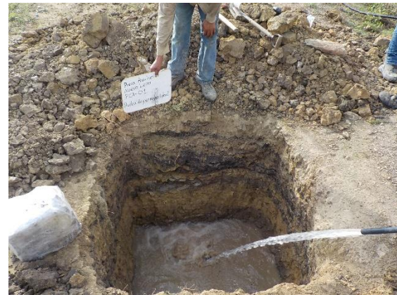
Fotografía III.17 Prueba de permeabilidad en el PCA-1.
