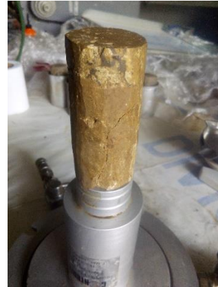
Fotografía III.41 Probeta despues del la prueba de compresión triaxial.
