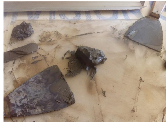
Fotografía III.35 Preparación del material para los límites de consistencia.
