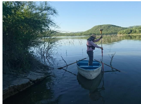
Fotografía III.7 Medición del nivel del azolve en el embalse de la presa Rancherías.
