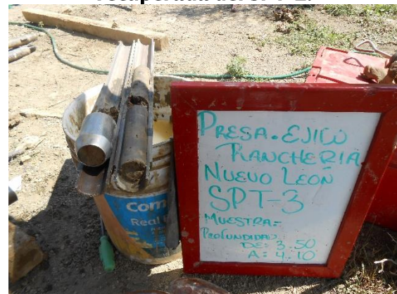
Fotografía III.33 Muestra de suelo recuperada del SPT-3.
