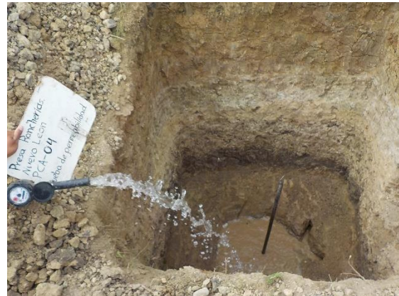
Fotografía III.23 Prueba de permeabilidad en el PCA-4.
