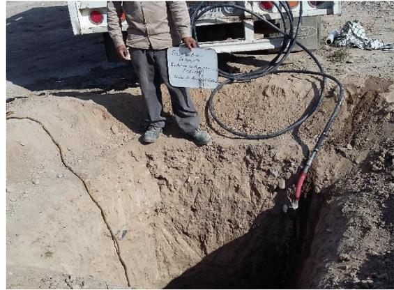
**Fotografía III.21** Prueba de permeabilidad en el PCA-4.
