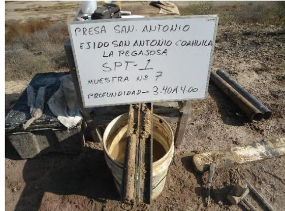
**Fotografía III.27 Muestra de suelo recuperada del SPT-1.**
