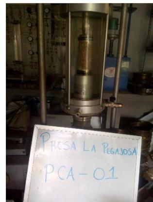
**Fotografía III.37 Probeta para prueba de compresión triaxial.**
