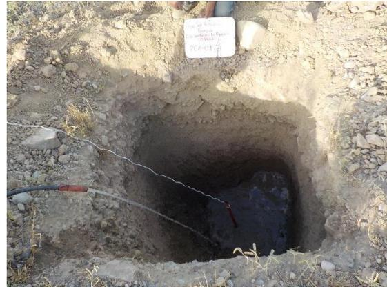
**Fotografía III.15** Prueba de permeabilidad en el PCA-1.
