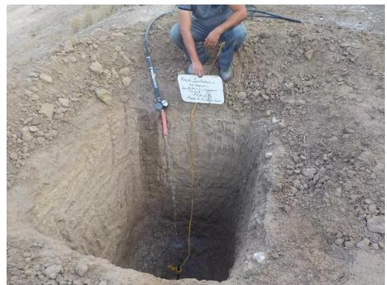
**Fotografía III.25** Prueba de permeabilidad en el PCA-6.
