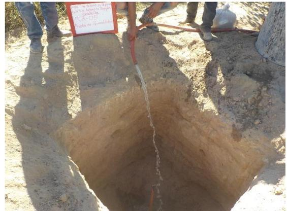
**Fotografía III.23** Prueba de permeabilidad en el PCA-5.
