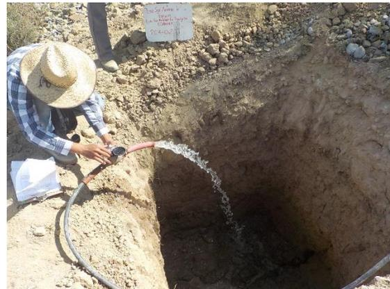
**Fotografía III.17** Prueba de permeabilidad en el PCA-2.
