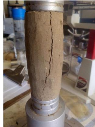
**Fotografía III.39 Probeta después de la prueba de compresión triaxial.**
