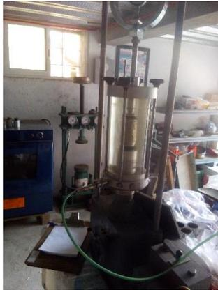
**Fotografía III.38 Prueba de compresión triaxial.**
