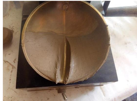
**Fotografía III.35 Prueba de límite líquido en copa de Casagrande.**
