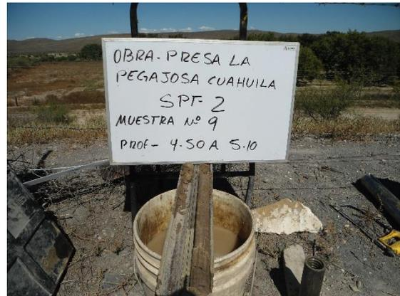
**Fotografía III.29 Muestra de suelo recuperada del SPT-2.**
