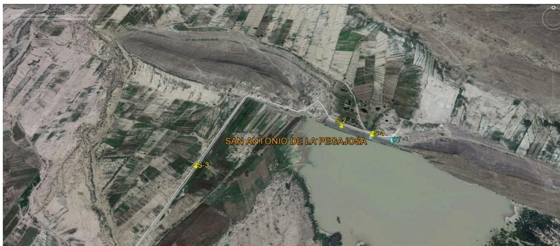
**Fotografía VII.3. Vista satelital de la cortina y posición de los tres sondeos: S-1 y S-2 en la cortina y el sondeo S-3 en el dique de la ribera de margen izquierda que falló en 2015.**
