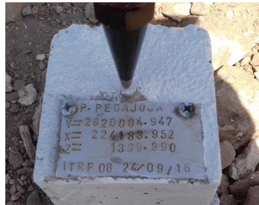
**Fotografía III.3 Coordenadas del vértice de referencia GPS1 en la presa San Antonio de la Pegajosa..**
