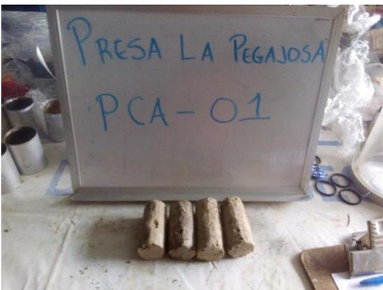
**Fotografía III.36 Probetas para prueba de compresión triaxial.**
