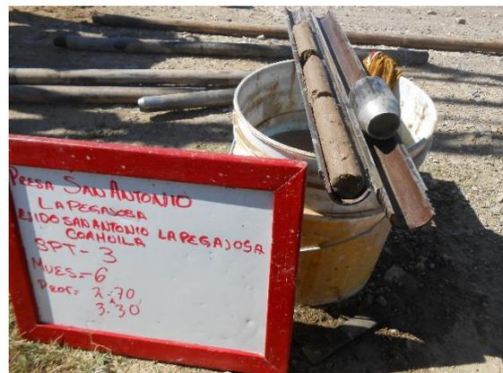
**Fotografía III.31 Muestra de suelo recuperada del SPT-3.**
