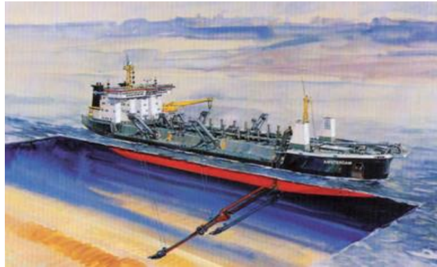
Figura 4.6. Draga de cántara con tubo de succión.
