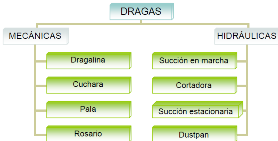
Figura 4.1. Clasificación de las dragas actuales.
