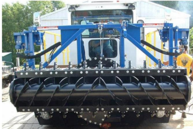
Figura 4.8. Cabezal de draga “Dustpan”.
