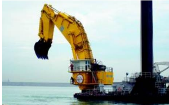
Figura 4.5. Dragas de pala.
