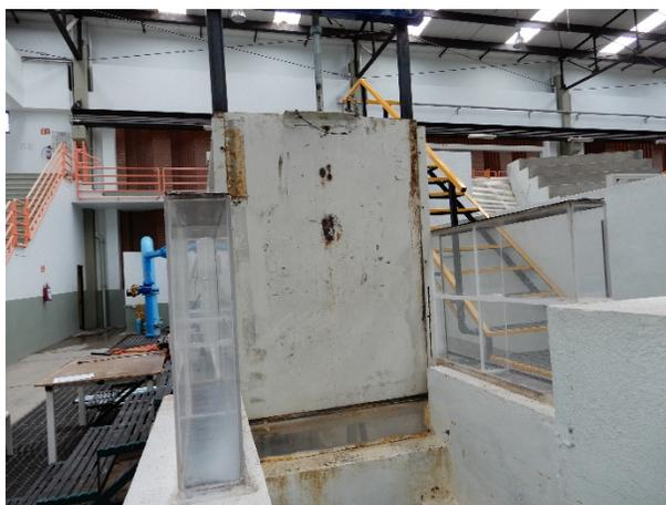
**Fotografía. 7. Compuerta de control de tirante al final del canal.**
