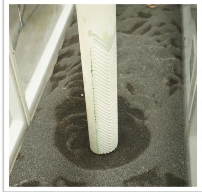
**Fotografía. 15. Pila con rugosidad direccional, P3, colocada en el canal de socavación en forma recta y rotada 45°**
