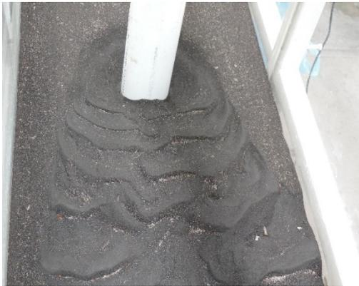
**Fotografía. 17. Morfología típica de la socavación producida por la pila lisa**
