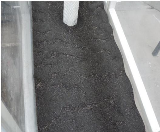
**Fotografía. 18. Morfología típica de la socavación producida por la pila rugosa**
