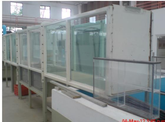
**Fotografía. 2. Canal de prueba de 60 cm de ancho por 8 metros de largo.**
