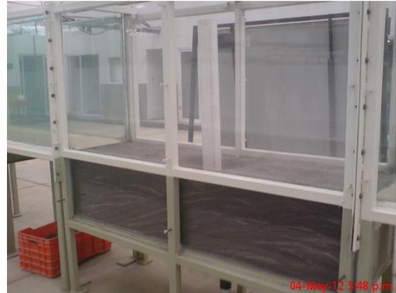
**Fotografía. 4. Tramo de pruebas (intermedio). Depósito de arena para prueba de socavación de la pila**
