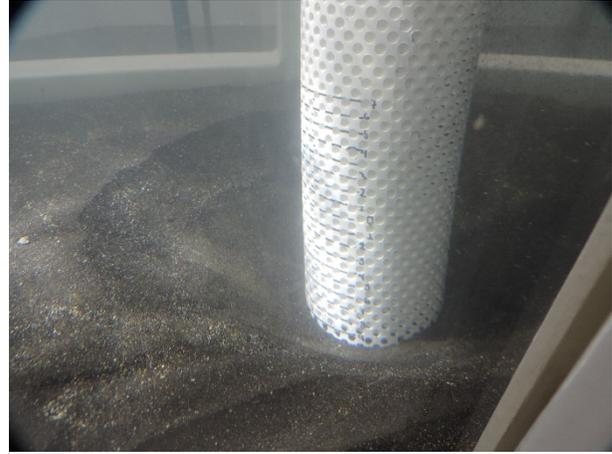
**Fotografía. 14. Pila lisa y con rugosidad P1 colocada en el canal de socavación.**
