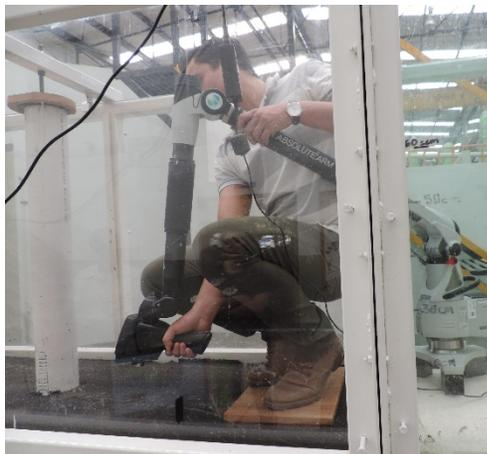
**Fotografía. 11. Levantamiento del fondo de arena modificado por la socavación con un scanner tipo lidar**
