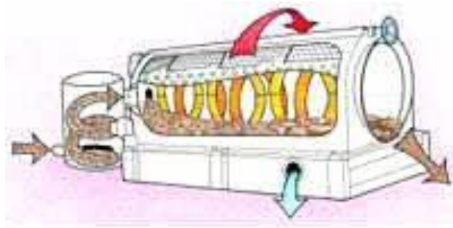
Fig. 5.67 Diagrama explicativo y vista de un espesador o filtro de tambor rotatorio (Parkson Corporation).
