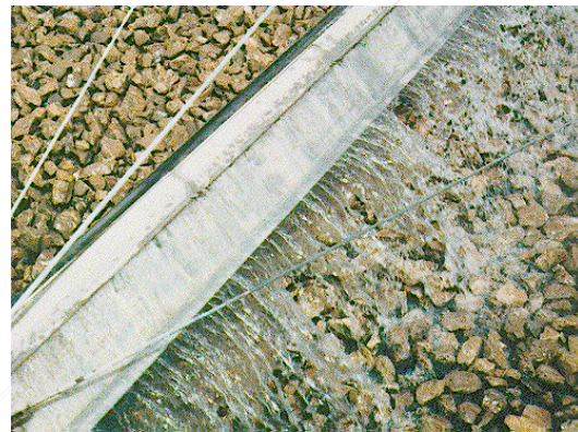
Fig. 6.5 Medio filtrante: piedra.
