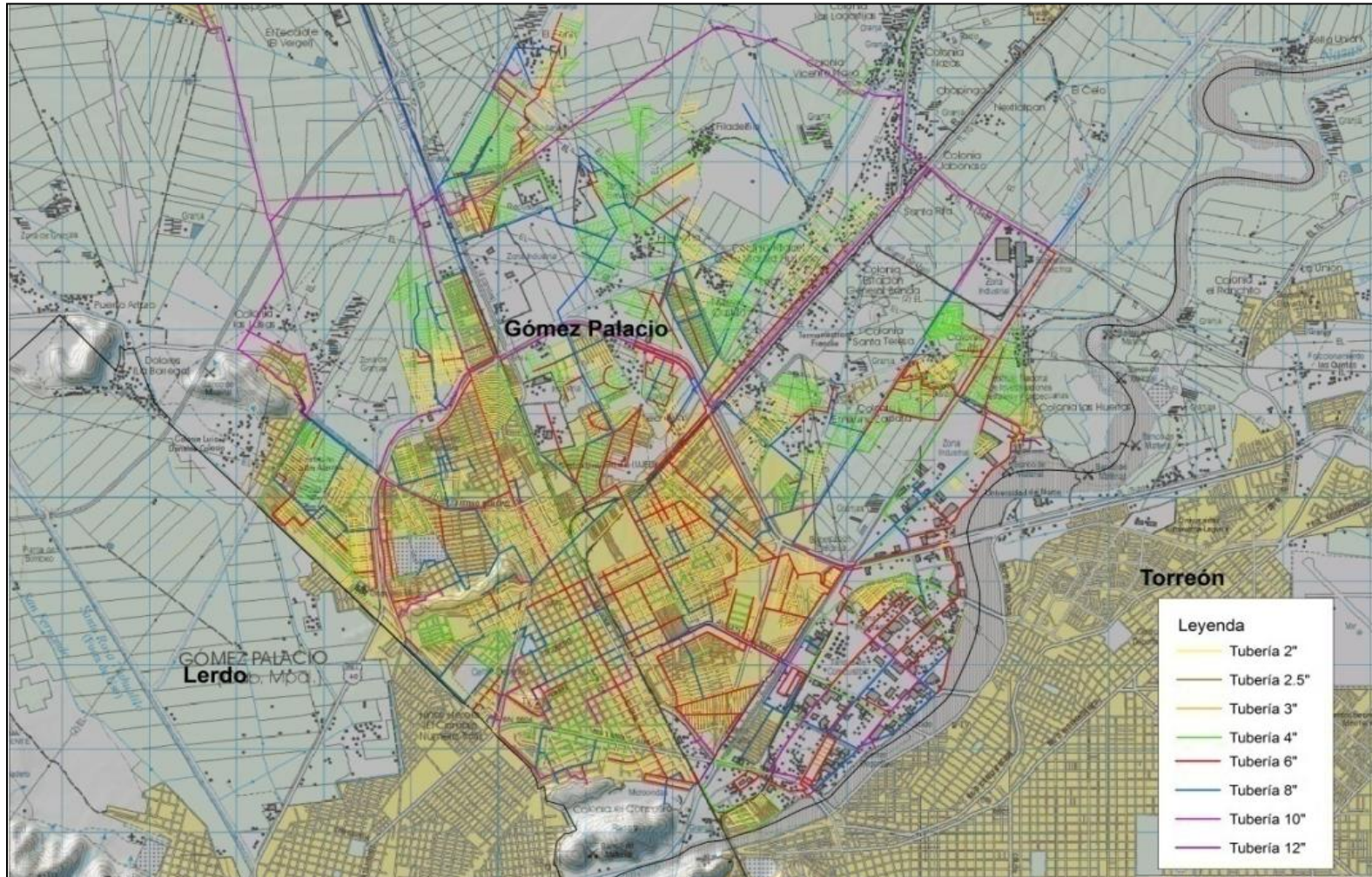
Ilustración 3-25 Red de agua potable de la localidad de Gómez Palacio, Durango Fuente: Gerencia Técnica SIDEAPA G.P.
