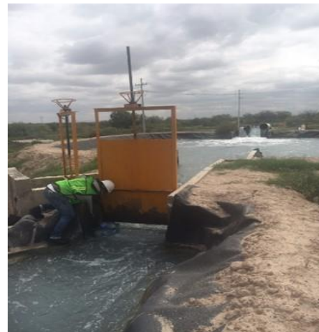
Ilustración 2-18 Toma de muestra para SDI a la salida de la pileta “623”
