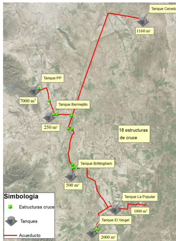
Ilustración 3-124 Cruces especiales a lo largo de la línea de conducción de agua potable Fuente: Elaboración propia
