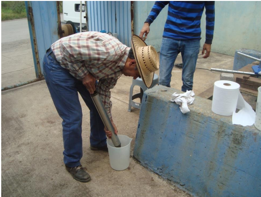
Figura 1.2.1 Toma de muestras de agua en el pozo Mixquic 1
