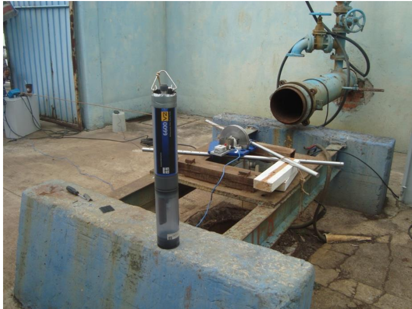
Figura 1.1.3 Medición de parámetros físico-químicos en campo del pozo Mixquic 1
