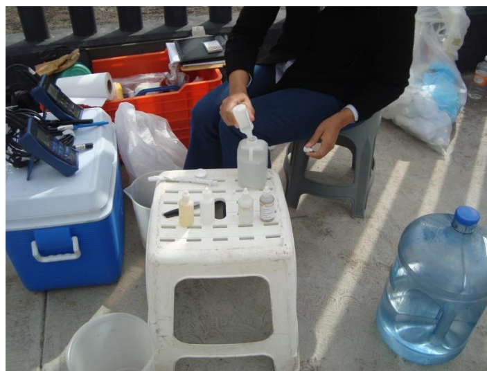
Figura 1.2.4 Toma de muestras de agua en el pozo Mixquic 5
