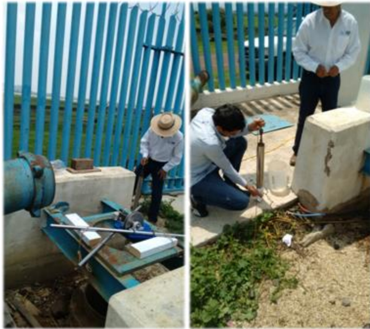
Figura 1.2.5 Toma de muestras de agua en el pozo Mixquic 10
