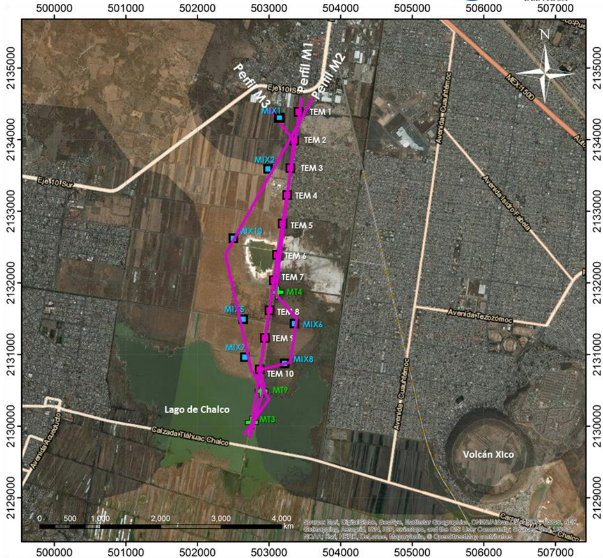
Figura 2.1.2.6 Perfiles geoelectricos (M1, M2 y M3)
