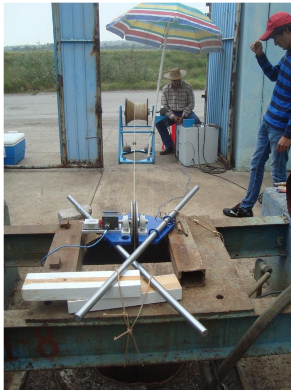
Figura 1.1.2 Medición de parámetros físico-químicos en campo del pozo Mixquic 1
