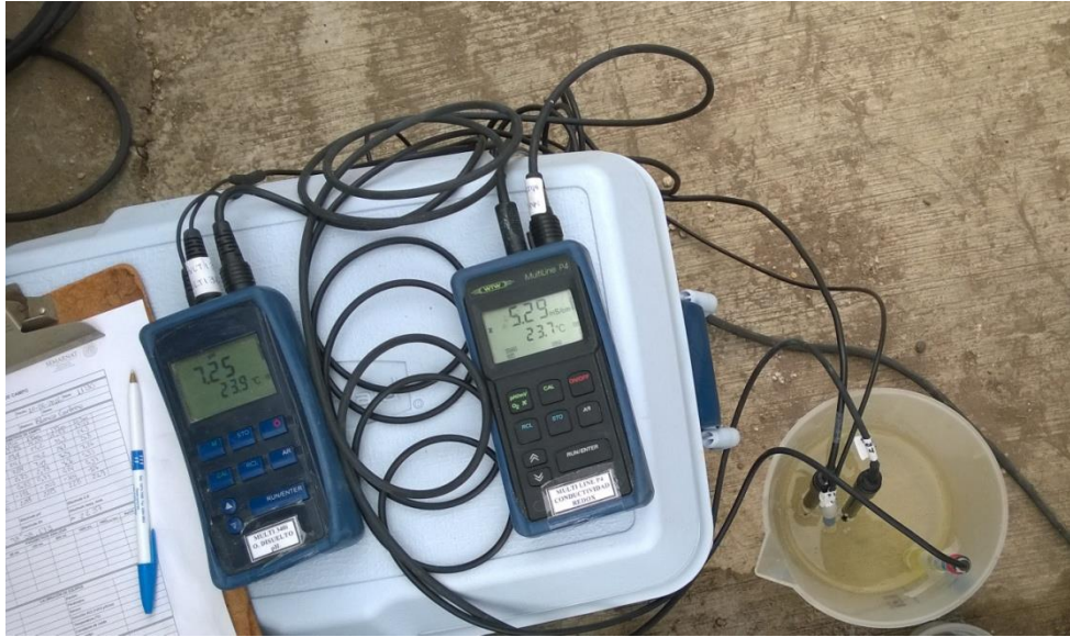
Figura 1.1.5 Medición de parámetros físico-químicos en campo del pozo Mixquic 5
