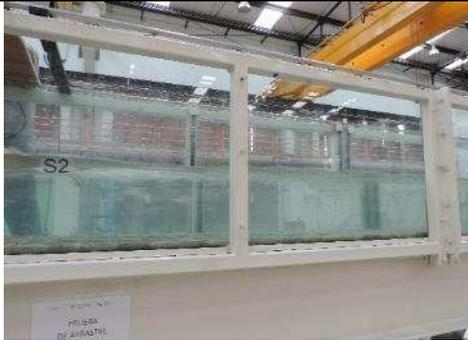
**Fotografía 25. Prueba de arrastre del tapete D1 e=23 cm, para un Q=295.658 l/s y s=0.0087.**
