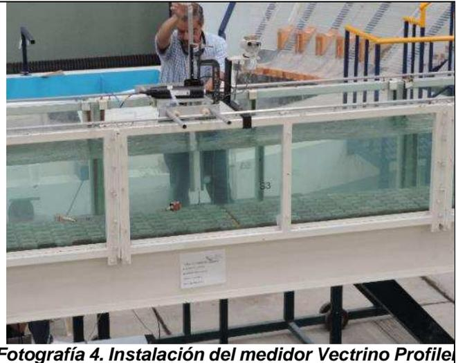
**Fotografía 4. Instalación del medidor Vectrino Profile**
