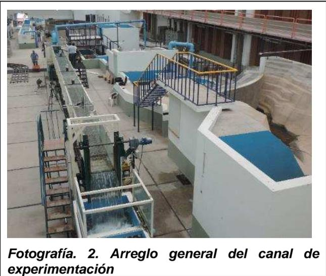
En la fotografía 2 se aprecian los medidores de nivel ultrasónicos utilizados en las pruebas. Es importante mencionar que el tramo inicial del canal, antes del tapete, se cubrió con una capa de material de espesor igual al del tapete, con la finalidad de evitar que el tapete presente directamente al flujo, el área proyectada de su espesor, de esta forma se tiene como componente de arrastre solo la de fricción.
