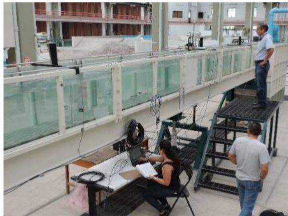
**Fotografía 6. Vista del canal de pendiente variable con sensores de nivel.**
