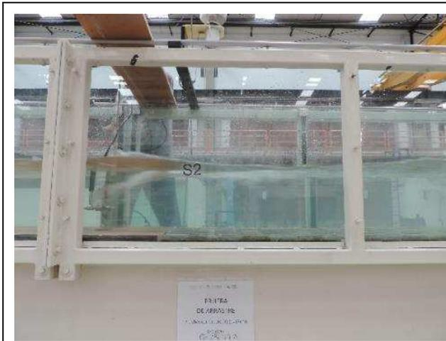
**Fotografía 21. Prueba de arrastre del tapete D1  $e=12$  cm, para un  $Q=296.029$  l/s y  $s=0.0087$ .**
