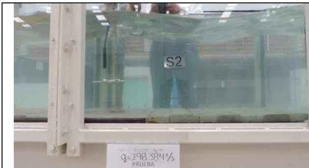
**Fotografía 23. Prueba de arrastre del tapete D1  $e=17$  cm, para un  $Q=298.384$  l/s y  $s=0.0087$ .**
