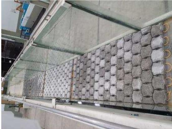
**Fotografía 16. Colocación de tapetes D1 Armorshield de 12 cm de espesor.**
