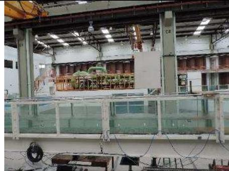
**Fotografía 26. Vista de perfil de prueba de arrastre del tapete D1 e=23 cm.**
