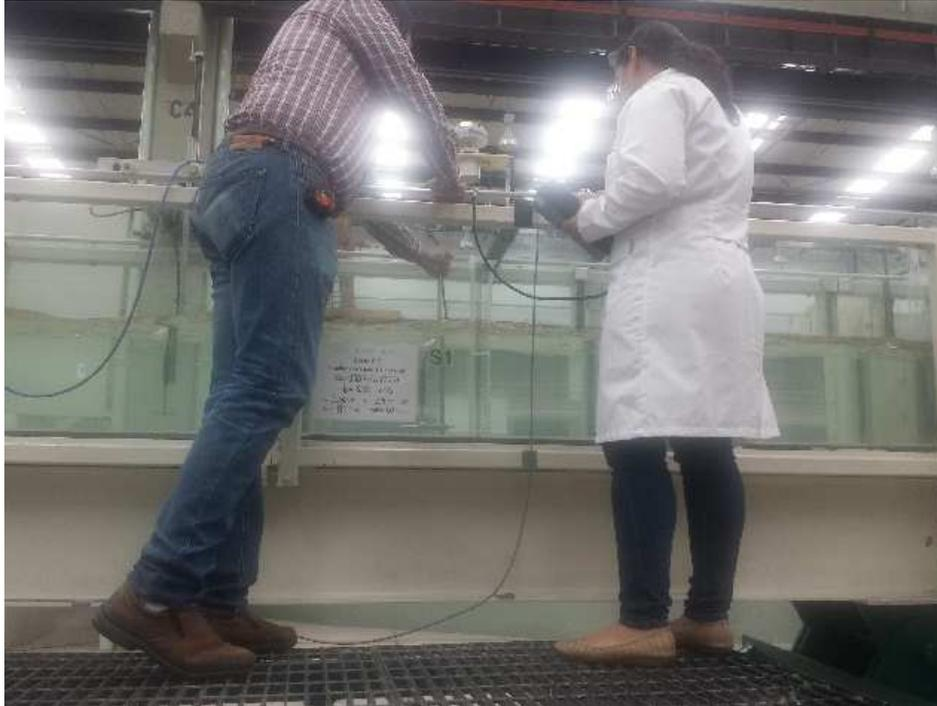
**Fotografía 18. Medición de velocidades con el Flow-Tracker**
