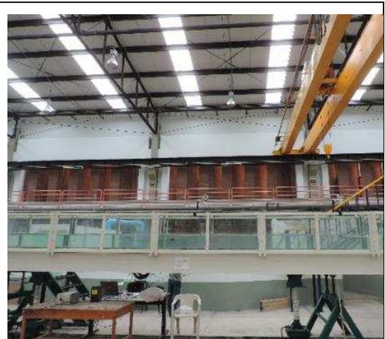
**Fotografía 22. Vista de perfil de prueba de arrastre del tapete D2  $e=12$  cm.**
