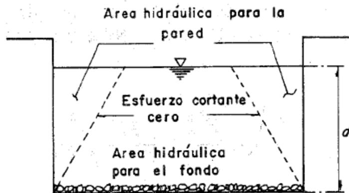
**Ilustración 12. Definición de la sección de rugosidad compuesta.**
