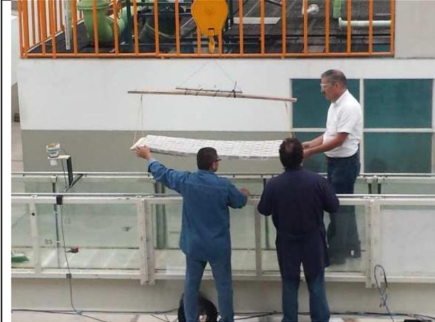
**Fotografía 16. Colocación de tapetes D2 ARMORPIN de 12 cm de espesor.**
