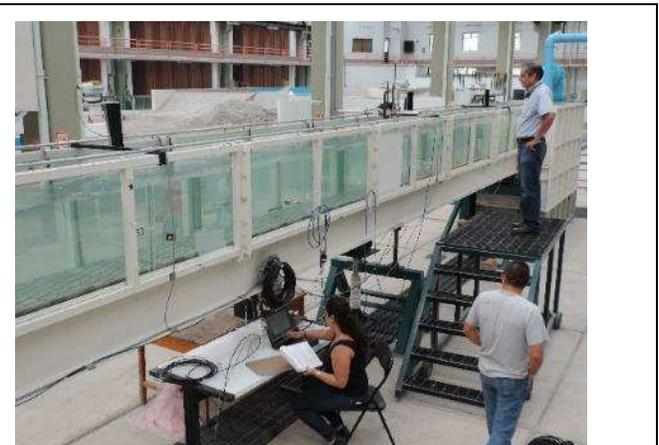
**Fotografía 6. Vista del canal de pendiente variable con sensores de nivel.**
