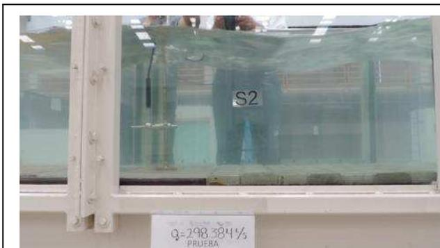
**Fotografía 23. Prueba de arrastre del tapete D2  $e=17$  cm, para un  $Q=298.384$  l/s y  $s=0.0087$ .**
