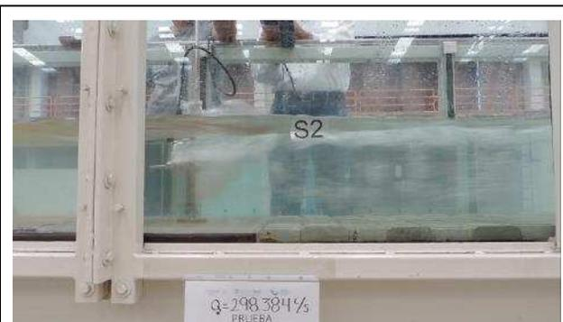
**Fotografía 24. Vista de perfil de prueba de arrastre del tapete D2  $e=17$  cm.**
