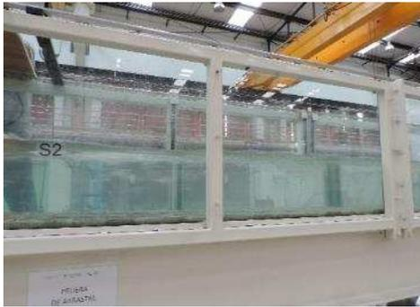
**Fotografía 25. Prueba de arrastre del tapete D2 e=23 cm, para un Q=295.658 l/s y s=0.0087.**
