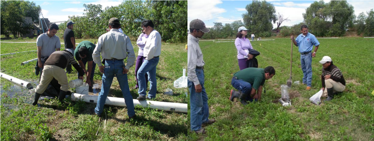
Fotos 4.4.12 y 4.4.13. Aforo del tubo completo y toma de muestra de suelo para contenido de humedad
