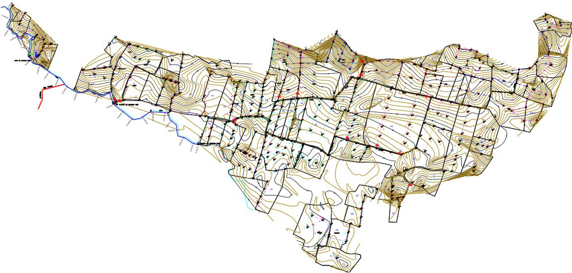
Zona baja. Presión en nodos y velocidad en tubería.
