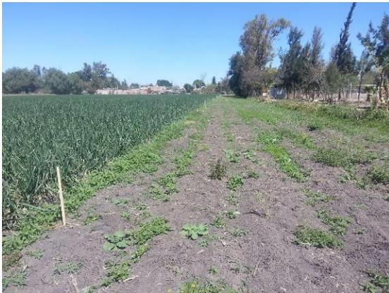
Ilustración 1.7.38 Marcas para medir tiempos de avance en prueba de riego (@25m). Parcela 6615.
