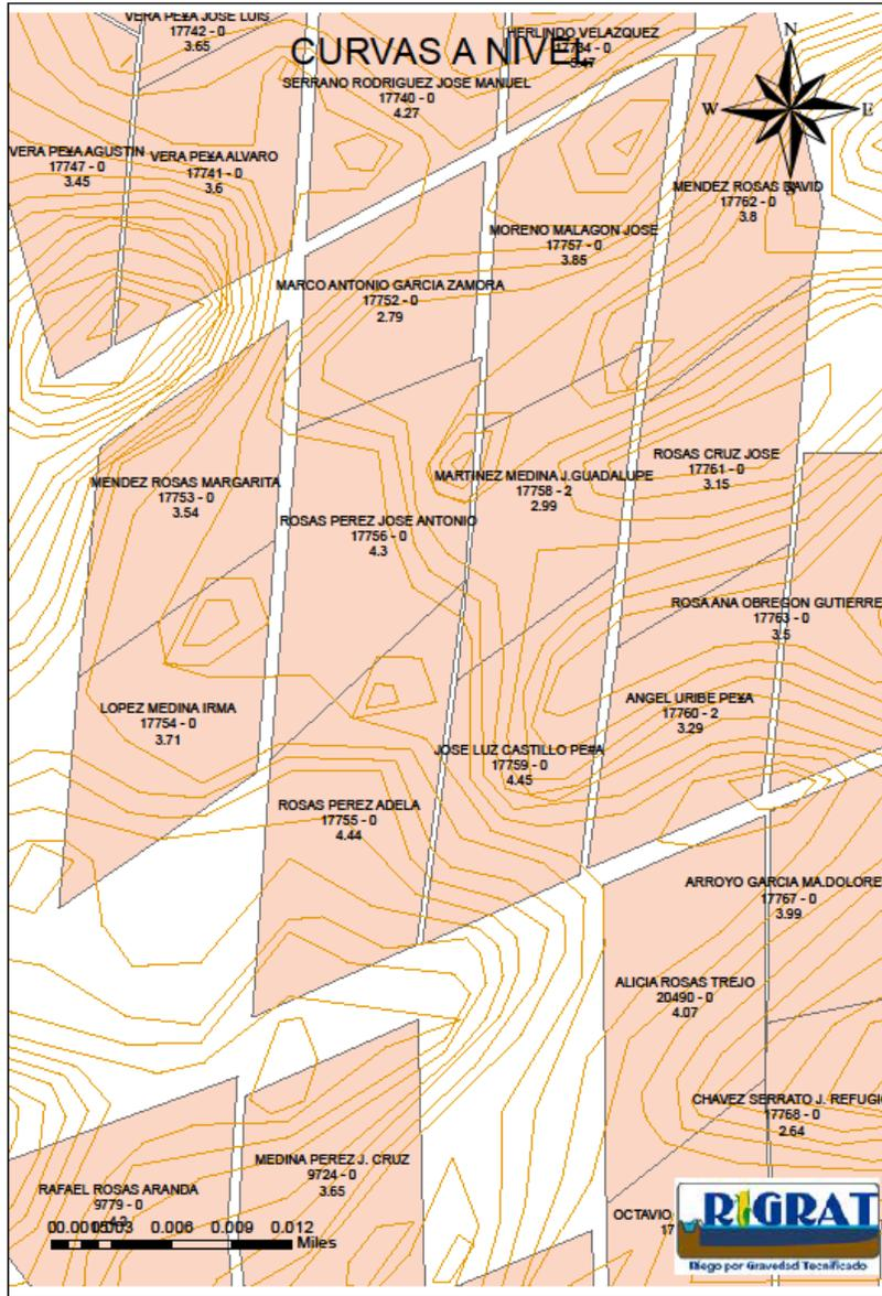
Ilustración 1.4.83. Plano de curvas de nivel en la zona compacta del Módulo Salvatierra.
