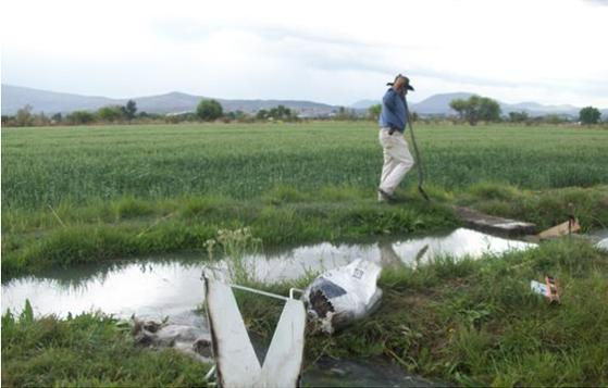
Ilustración 1.7.49. Aforo con vertedor triangular. Cta. 20369-0.
