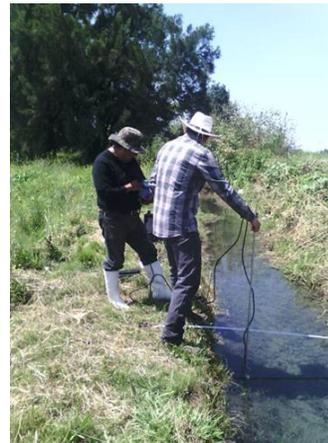
Ilustración 1.7.57. Aforos realizados en el Módulo de Valle de Santiago.
