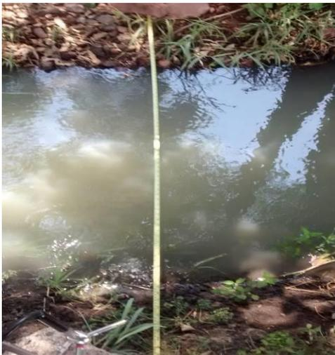
Ilustración 1.7.55. Medición del ancho de la regadera para determinar el número de secciones.
