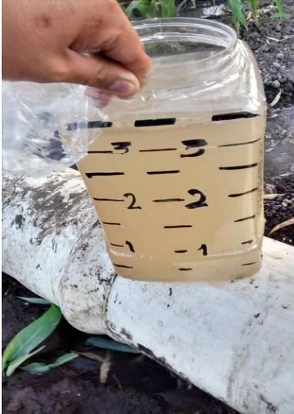
Ilustración 1.7.53. Aforo volumétrico con recipiente calibrado.
