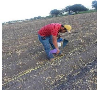
Ilustración 1.7.41. Establecimiento de marcas para medición de avances en pruebas de riego. Parcela 6594.
