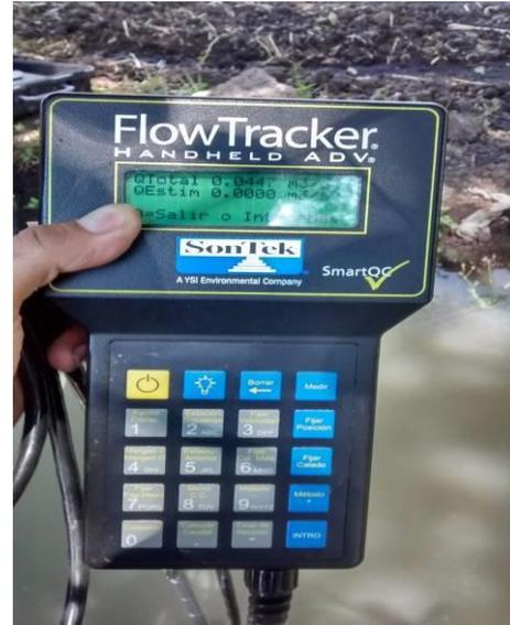
Ilustración 1.7.54. Aforo mediante instrumento electrónico "Flow tracker", obteniendo un gasto de 44 l/s.
