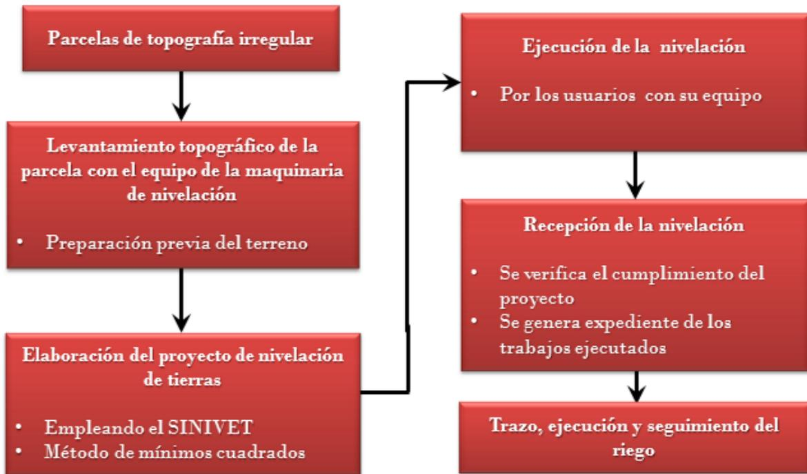
**Figura I.4.** Esquema de trazo y diseño de riego por gravedad en parcelas de topografía irregular.
