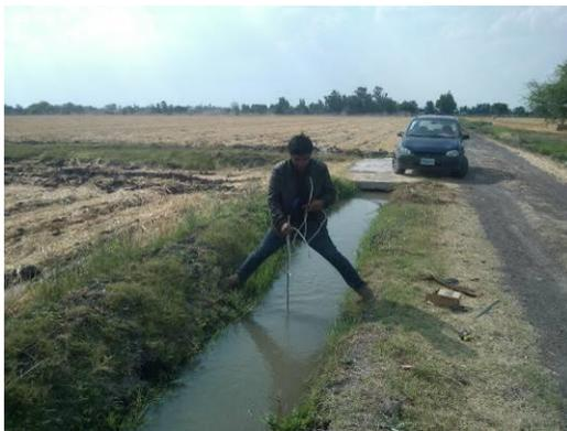
Ilustración 1.7.58. Aforo con molinete Pígameo.
