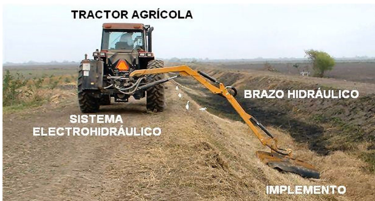
Figura 1. Partes de un equipo ligero empleado para el control de maleza en los Distritos de Riego de México.
