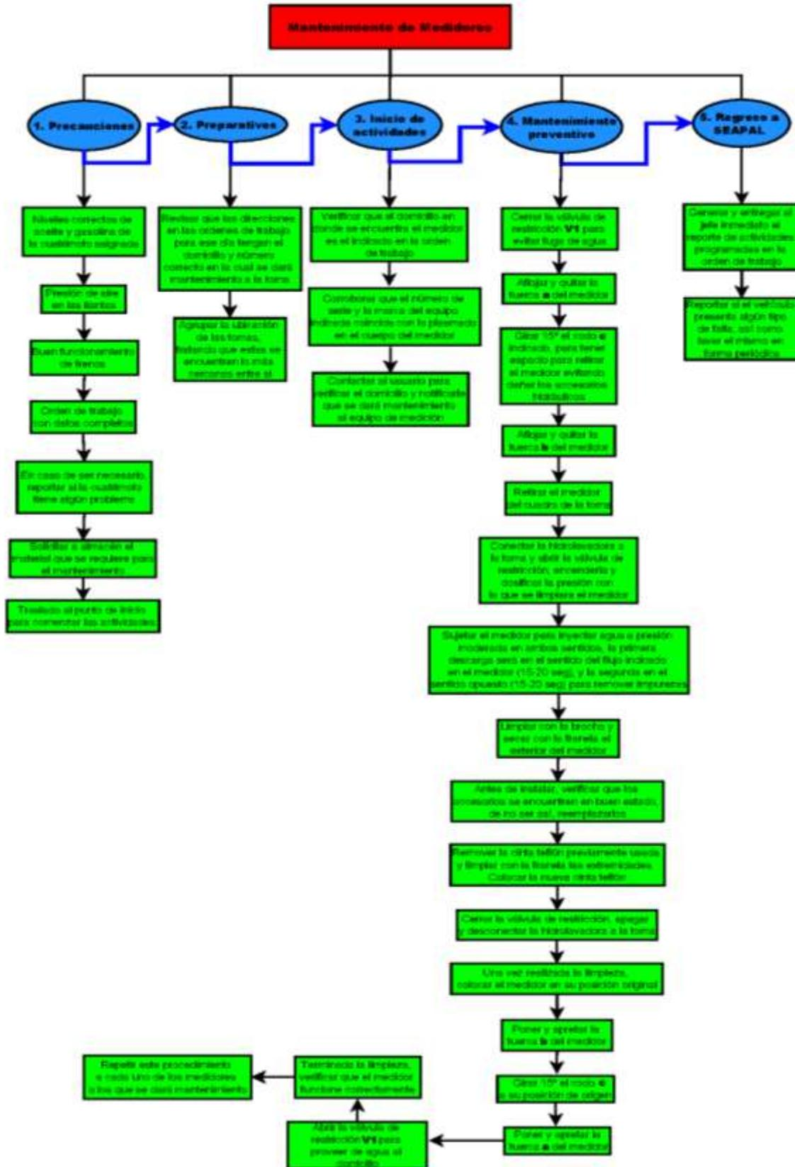
Figura 26. Diagrama de flujo para el procedimiento de mantenimiento de medidores
