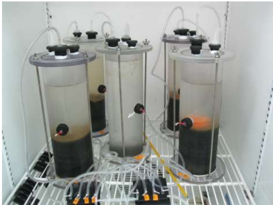
Figura 71 Cámaras de incubación preparadas e instaladas en refrigerador.
