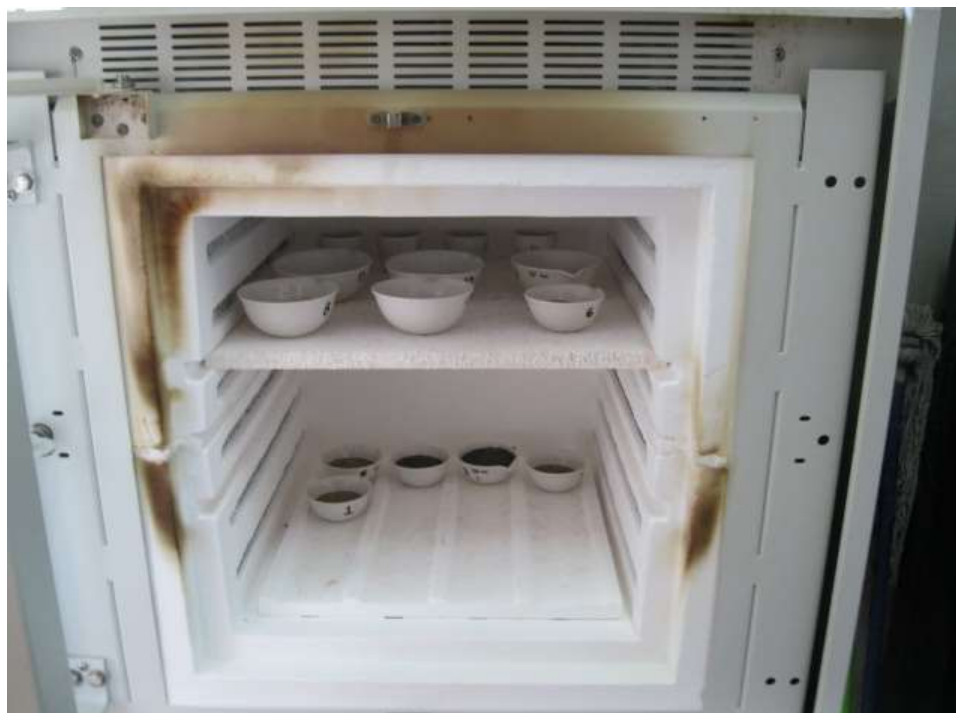
Figura 67 Calcinación de muestra de sedimento para determinación de materia orgánica.
