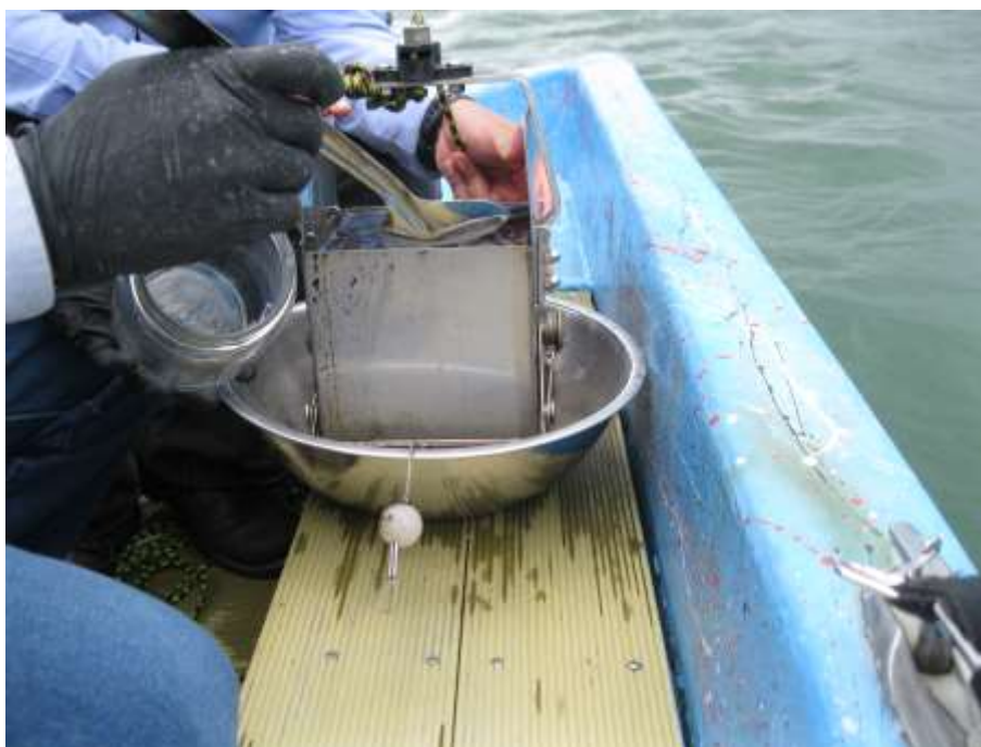
Figura 64 Obtención de muestra de sedimento en la presa Valle de Bravo mediante draga Ekman.
