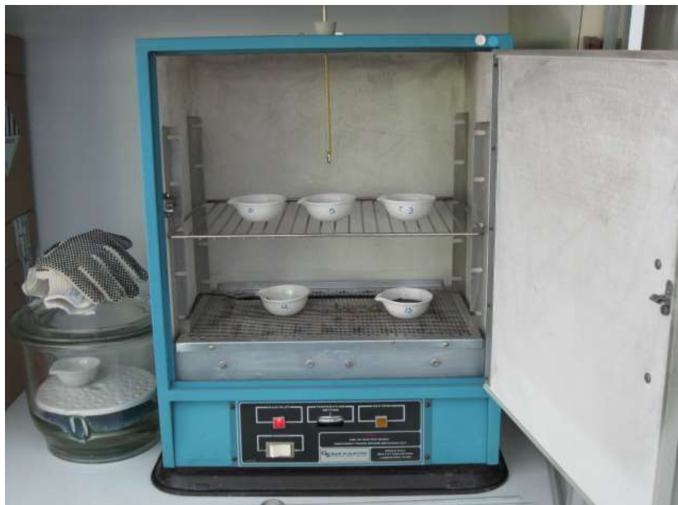
Figura 66 Secado de sedimento en estufa.
