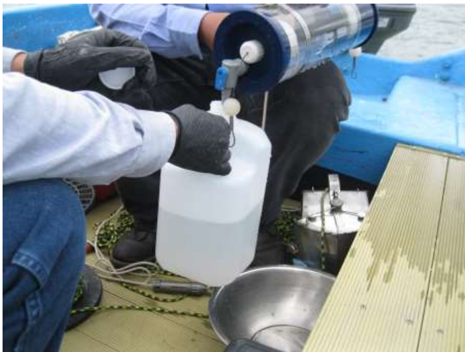
Figura 63 Obtención de muestra de agua en la presa Valle de Bravo mediante botella van Dorn.
