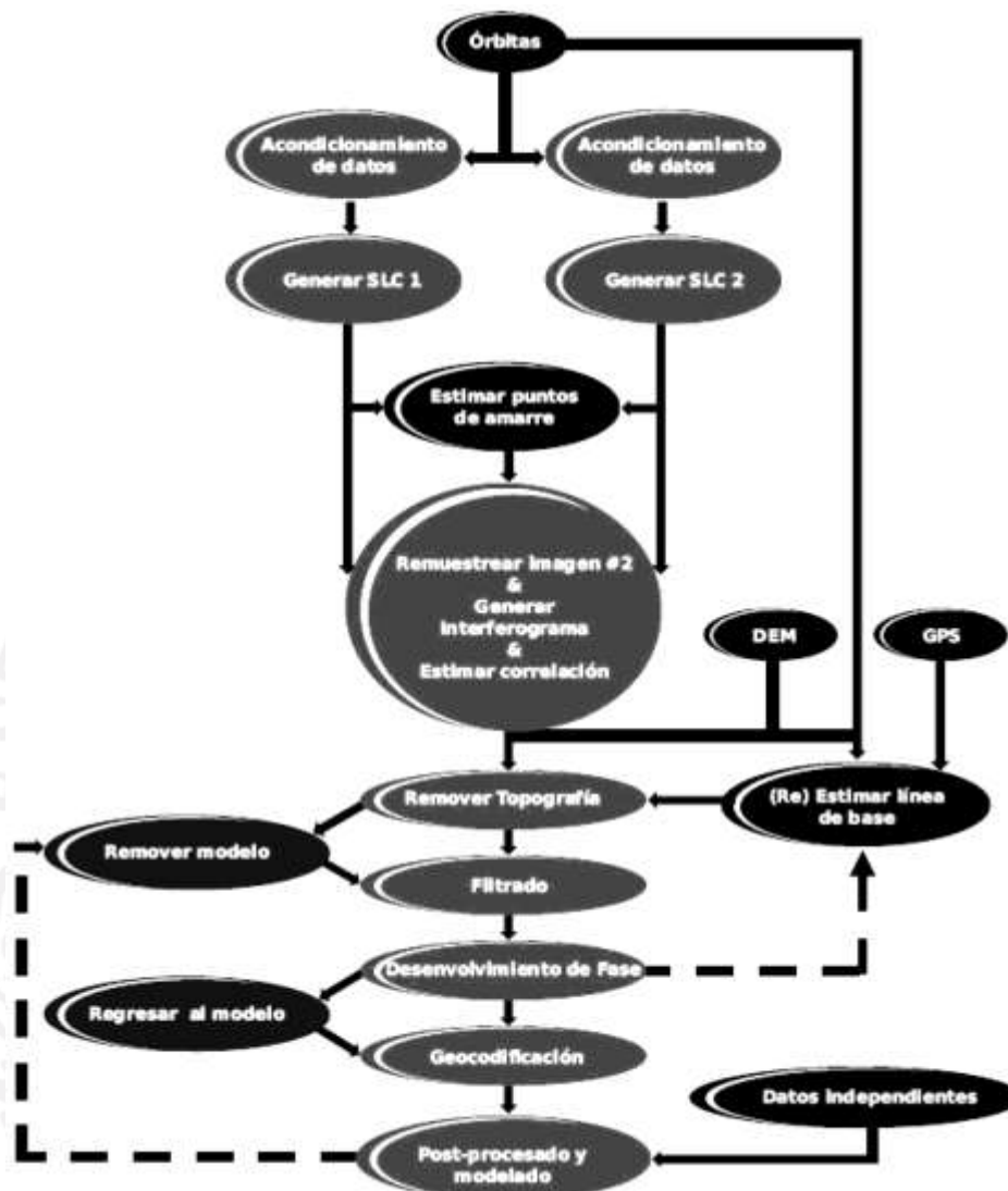
Figura 31. Diagrama de flujo que sigue ROI PAC para generar mapas interferométricos (Fuente: Fielding, 2009, p. 4, modificado por Covarrubias-Calderón, 2016, p. 11).
