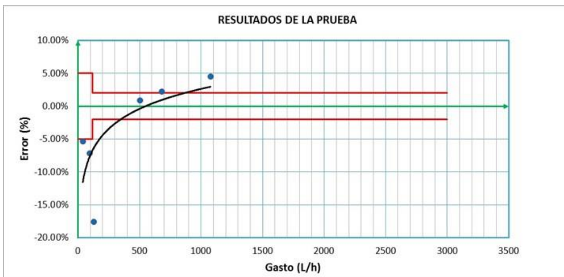
Figura 65. Resultado de la prueba volumétrica realizada al usuario 0301113110, que está funcionando fuera de los límites permisibles de acuerdo a la norma NOM-042-SCFI-1997
