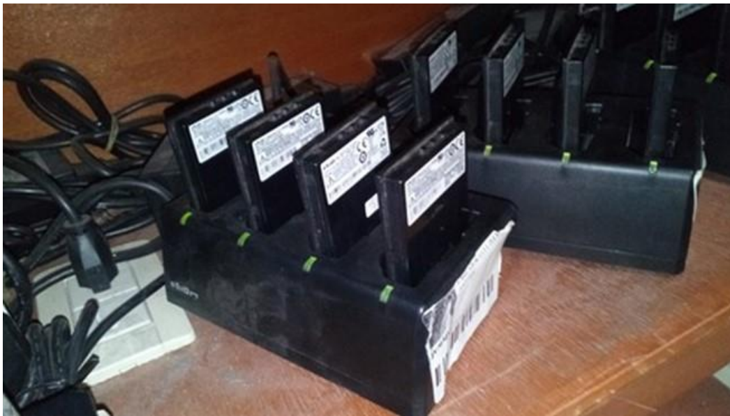
Figura 62. Baterías y centro de recarga para las Hand Hells
