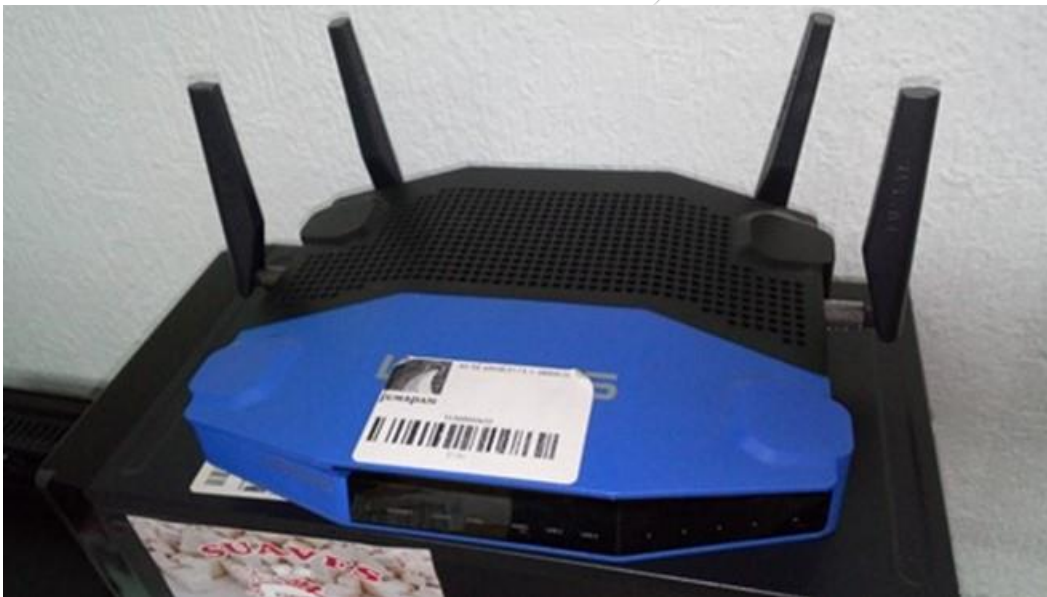
Figura 63. Modem que permite la transmisión de las lecturas entre las Hand Hells y el Sistema Comercial
