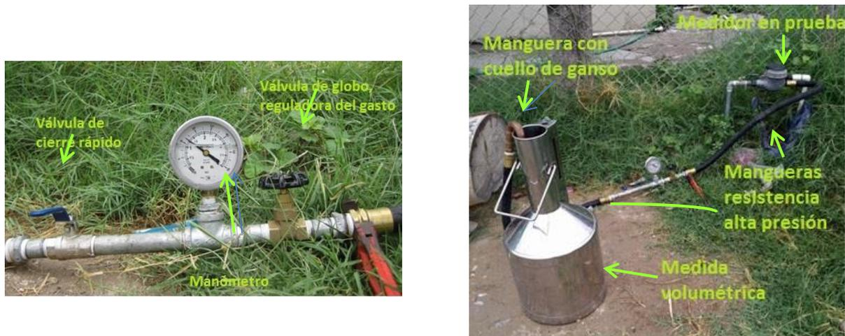
Ilustración 29 Equipos y herramientas para verificar la medición de los medidores.
