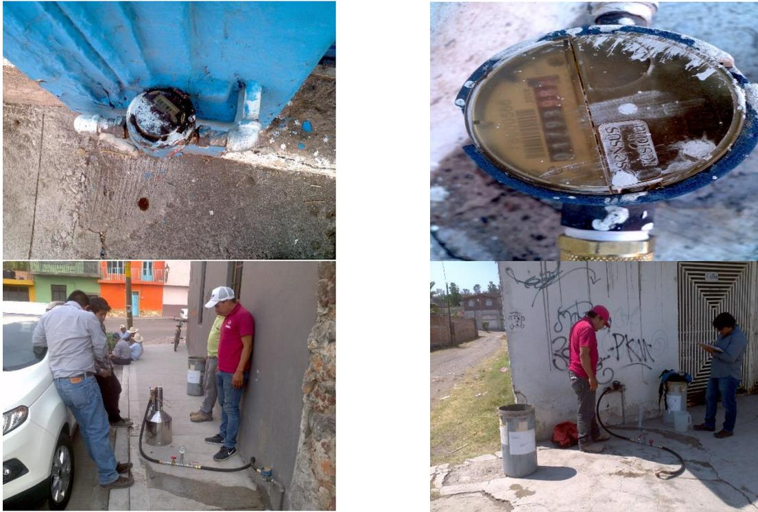
Ilustración 31 Pruebas de medición de flujo en tomas domiciliarias. Fuente: Elaborado por el IMTA.
