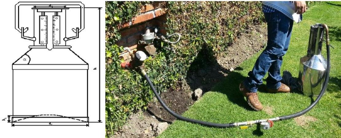
Ilustración 28 Equipos y herramientas para verificar la medición de los medidores.
