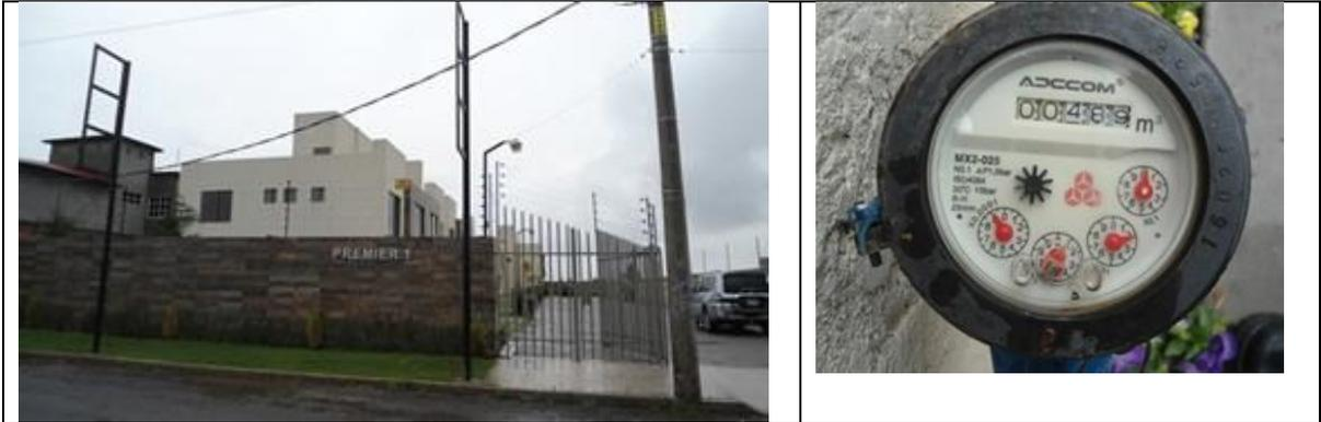
**Figura 38.** Auditoría en medidor del usuario 11556. Serie 11556, DN 25 mm, clase B. Medición 45 min.
