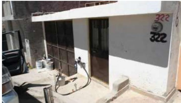
**Figura 73.** Prueba de errores del medidor 091130374 clase B, N 1.5 m<sup>3</sup>/h, DN 15 mm, año de fabricación 2009, usuario doméstico 123629. Fecha 03 de abril 2018.
