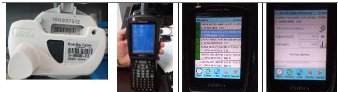
**Figura 67.** Medidor equipado con lectura remota, terminal (hand held) recolectora, y pantalla de terminal con lista de usuarios a los que se toma la lectura vía remota; pantalla con lectura recibida y lectura anterior para un cierto usuario.
