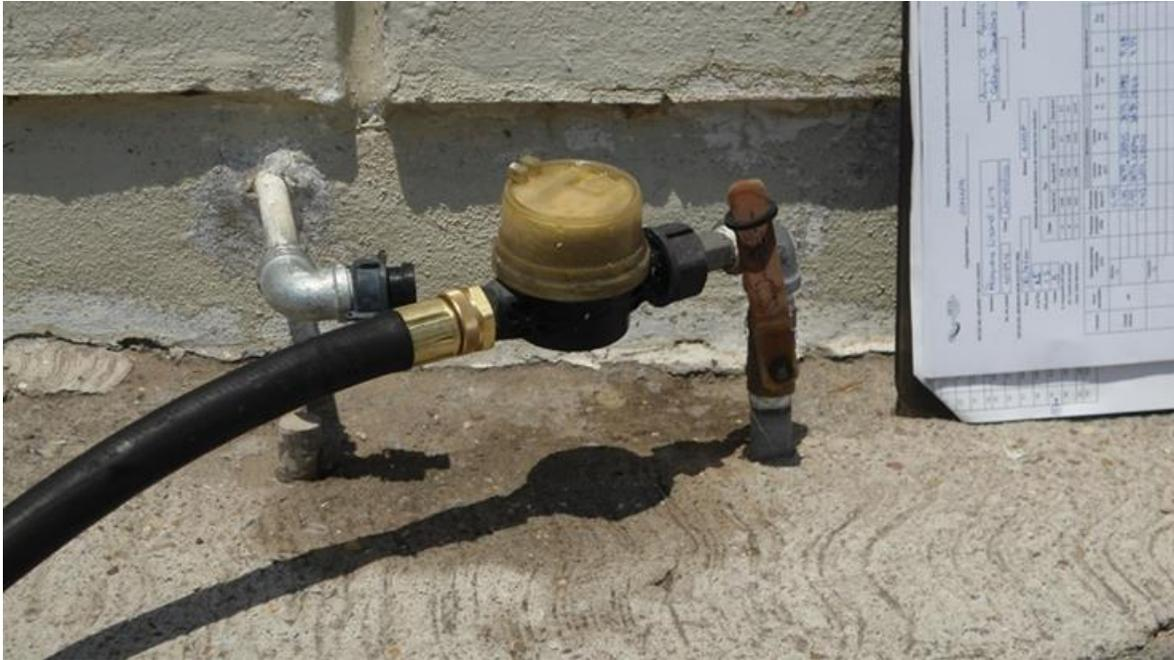
**Figura 53.** Realizando prueba volumétrica al medidor del usuario 41494
