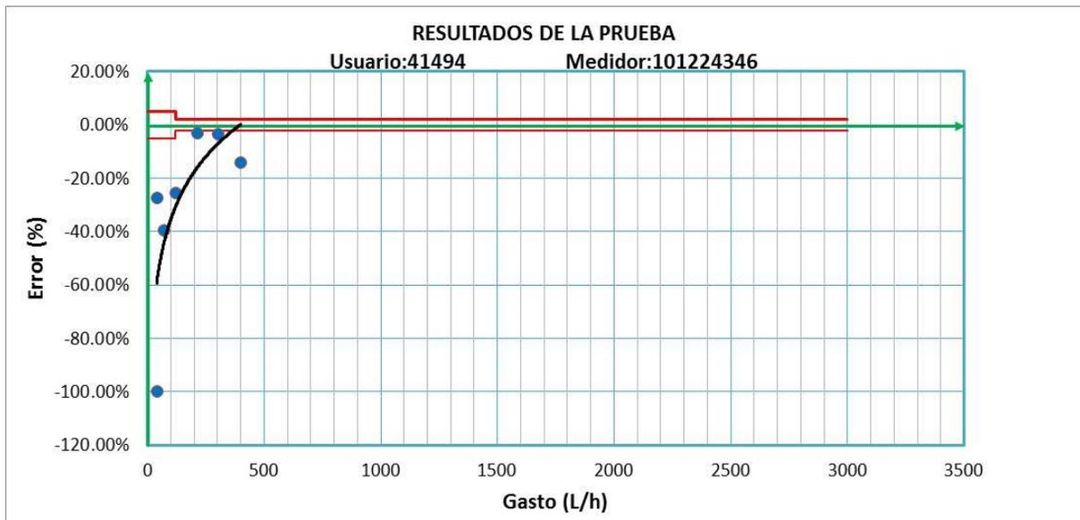
**Figura 54.** Resultado de la prueba volumétrica realizada al usuario 41494, funcionando fuera de los límites permisibles de acuerdo a la norma NOM-042-SCFI-1997
