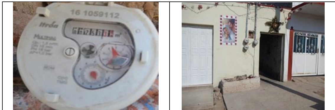
Figura 2. Medidor Itron, Multimag 161059112, clase C, sin VAF. Detalles de medidor con número de serie. Comunidad Ajuchitlán, municipio de Colón. Lectura del medidor: 253.30 m 3 .
