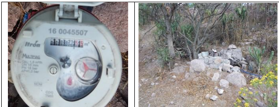
Figura 5. Medidor Itron, Multimag 160045507, clase C, sin VAF. Detalles de medidor con número de serie. Comunidad El Coyote, municipio de Colón. Lectura del medidor: 91.5 m 3 . Casa alejada de la toma.
