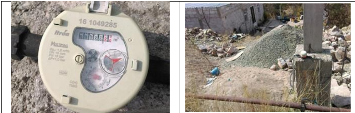
Figura 22. Medidor Itrón, Multimag 161049285, clase C, con VAF1. Detalles de medidor con número de serie. Comunidad San Antonio de la Cal, municipio de Colón. Lectura del medidor: 56.882 m3.
