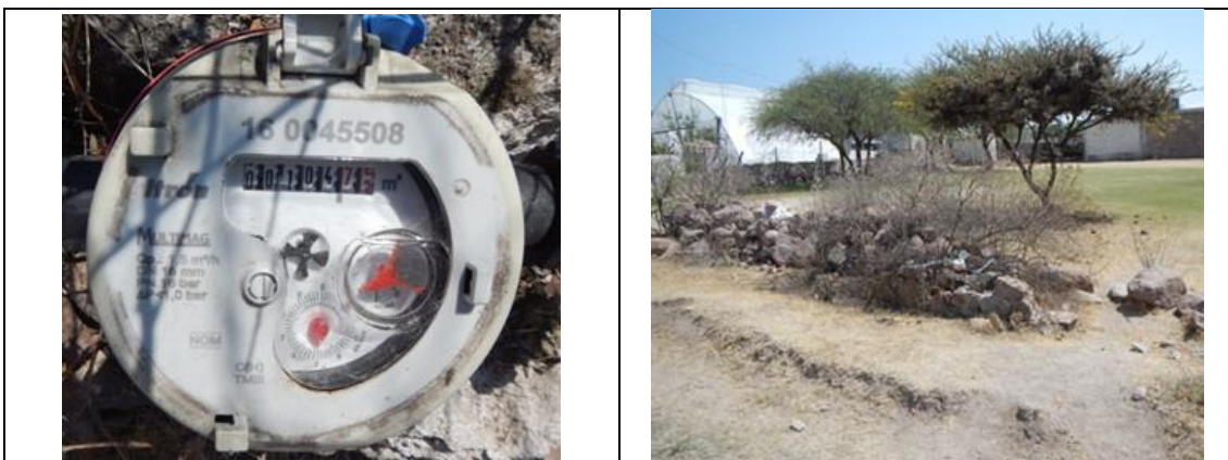
Figura 9. Medidor Itron, Multimag 160045508, clase C, sin VAF. Detalles de medidor con número de serie. Comunidad El Saucillo, municipio de Colón. Lectura del medidor: 104.73 m3. Casa alejada de la toma.
