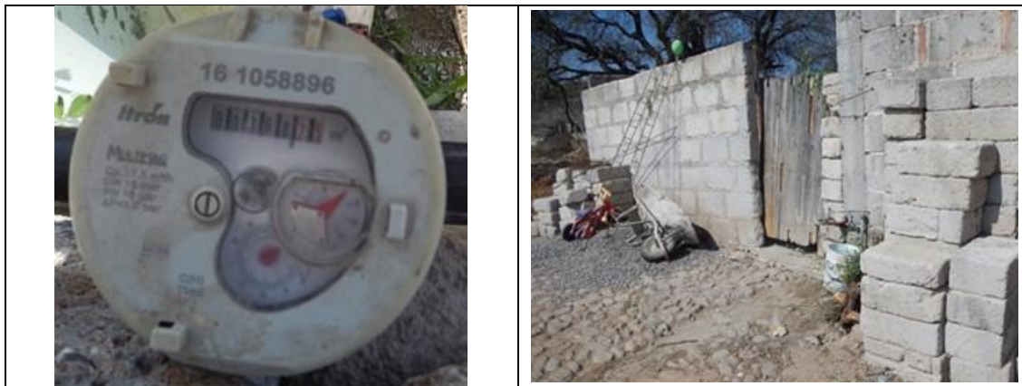
Figura 4. Medidor Itron, Multimag 161058896, clase C, sin VAF. Detalles de medidor con número de serie. Comunidad Colón, municipio de Colón. Lectura del medidor: 168.75 m 3 . Existe válvula expulsora de aire, y el medidor no tiene tapa.
