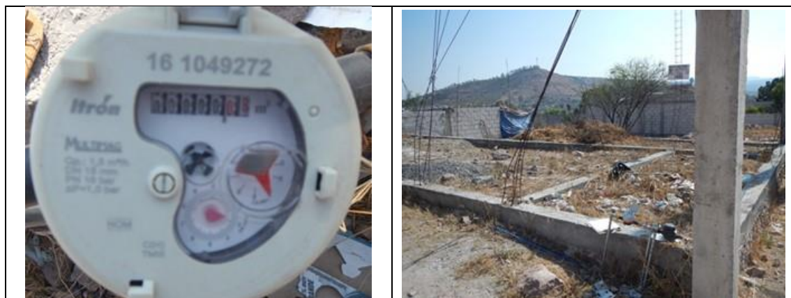
Figura 3. Medidor Itron, Multimag 161049272, clase C, sin VAF. Detalles de medidor con número de serie. Comunidad Colón, municipio de Colón. Lectura del medidor: 0.08 m 3 . Este medidor sustituyó al medidor con serie 160045275
