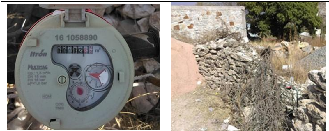
Figura 23. Medidor Itrón, Multimag 161058890, clase C, con VAF1. Detalles de medidor con número de serie. Comunidad San Antonio de la Cal, municipio de Colón. Lectura del medidor: 2.828 m3.
