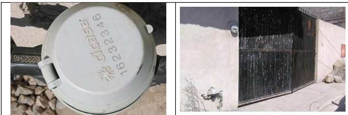
Figura 22. Medidor CICASA, MS Delaunet 16232346, clase B, sin VAF. Detalles de medidor con número de serie. Colonia Centro, municipio de Ezequiel Montes. Lectura del medidor: 56.285 m 3 .
