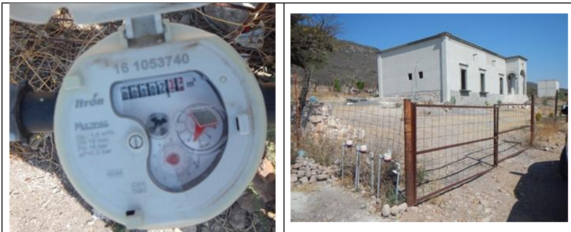
Figura 11. Medidor Itrón, Multimag 161053740, clase C, con VAF2 . Detalles de medidor con número de serie. Colonia Bernal, municipio de Ezequiel Montes. Lectura del medidor: 2.35 m 3 . La casa está aún en construcción y deshabitada.
