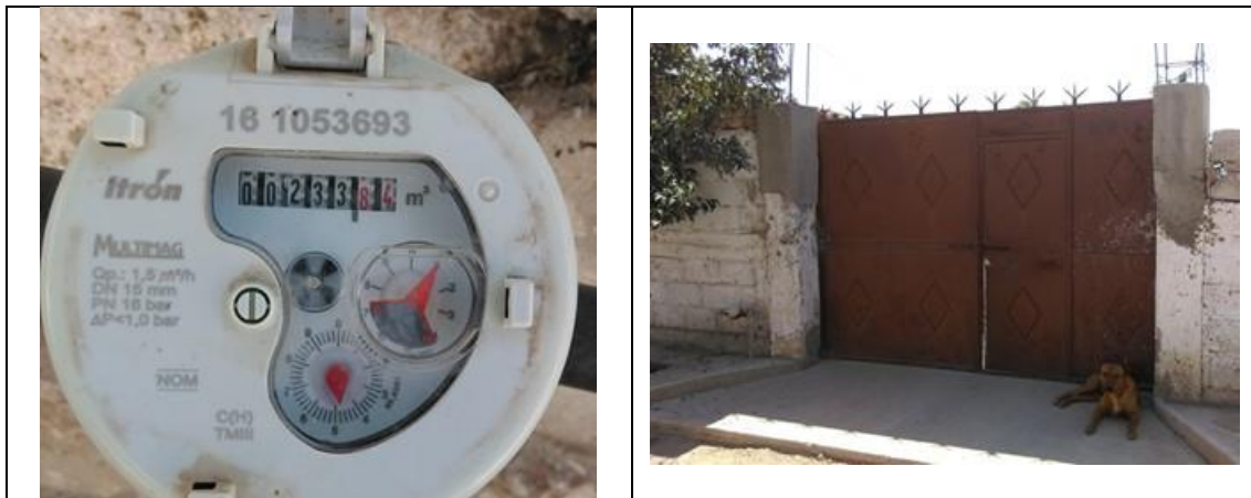
Figura 27. Medidor Itron, Multimag 161053693, clase C, sin VAF. Detalles de medidor con número de serie. Colonia La Purísima, municipio de Ezequiel Montes. Lectura del medidor: 233.840 m 3 .
