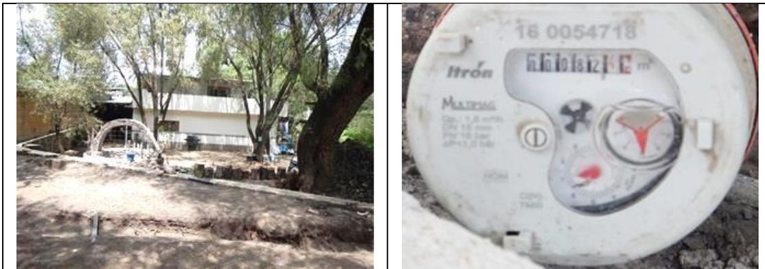
Figura 20. Medidor 160054718, clase C. Predio y detalle de medidor con número de serie. Sin VAF. Domicilio conocido S/N, localidad Los Cues. Lectura del medidor: 82.44 m<sup>3</sup>. Se encontró que el modelo del medidor no corresponde al registrado en el padrón de usuarios de la CEA.
