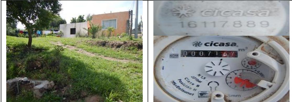
Figura 14. Medidor 16117889, clase B. Predio con toma y detalle de medidor con número de serie. Con VAF. Domicilio conocido S/N, localidad Carranza. Lectura del medidor: 71.67 m<sup>3</sup>. Se encontró que el modelo del medidor no corresponde al registrado en el padrón de usuarios de la CEA.
