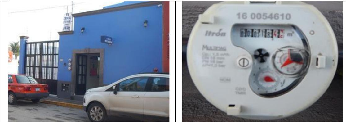
Figura 4. Medidor 160054610, clase C. Predio con toma y detalle de medidor con número de serie. Sin VAF. Calle Francisco I. Madero No. 91, col. Huimilpan Centro. Lectura del medidor: 18.44 m<sup>3</sup>. Se encontró que el modelo del medidor no corresponde al registrado en el padrón de usuarios de la CEA.
