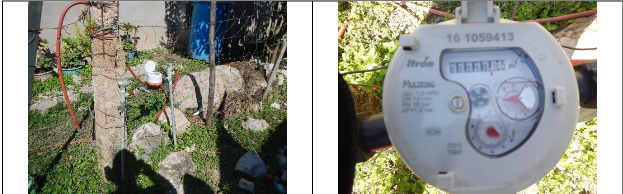
Figura 12. Medidor 161059413, clase C. Predio con toma y detalle de medidor con número de serie. Sin VAF. Localidad Encino Solo. Lectura del medidor: 30.11 m 3 . El número de medidor corresponde con el número proporcionado por la CEA, sin embargo la marca, modelo y características (clase) del medidor no corresponden a las registradas en el padrón de usuarios.
