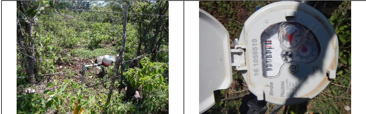
Figura 20. Medidor 161059519, clase C. Toma y detalle de medidor con número de serie. Sin VAF. Callejón Camino Real S/N, localidad Las Ánimas. Lectura del medidor: 59.26 m 3 . El número de medidor corresponde con el número proporcionado por la CEA, sin embargo, se encontró que la marca, modelo y demás características (clase) del medidor no corresponden al registrado en el padrón de usuarios de la CEA.
