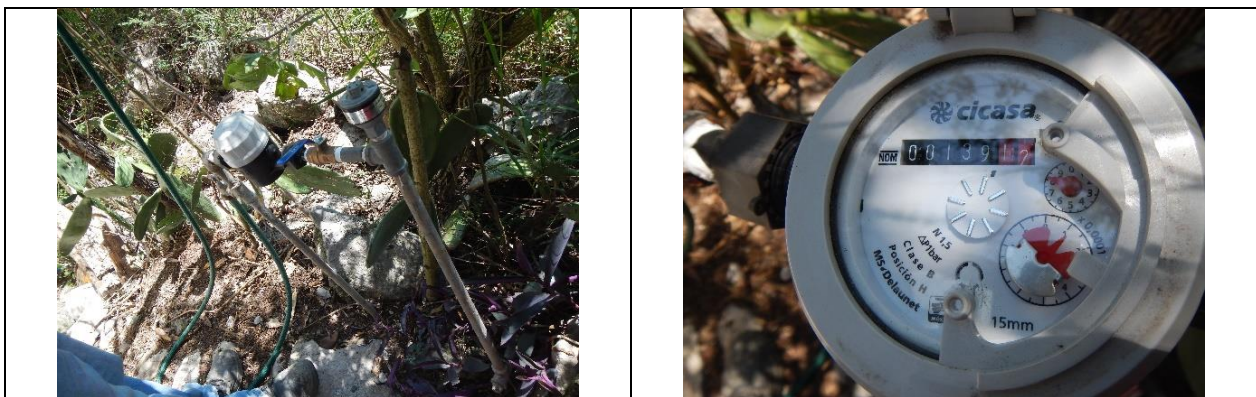
Figura 8. Medidor buscado 16230892, clase B. Sin VAF. Barrio San Esteban. Lectura del medidor: 139.12 m 3 . El modelo del medidor presenta diferencias con las características registradas por la CEA, en el padrón de usuarios.
