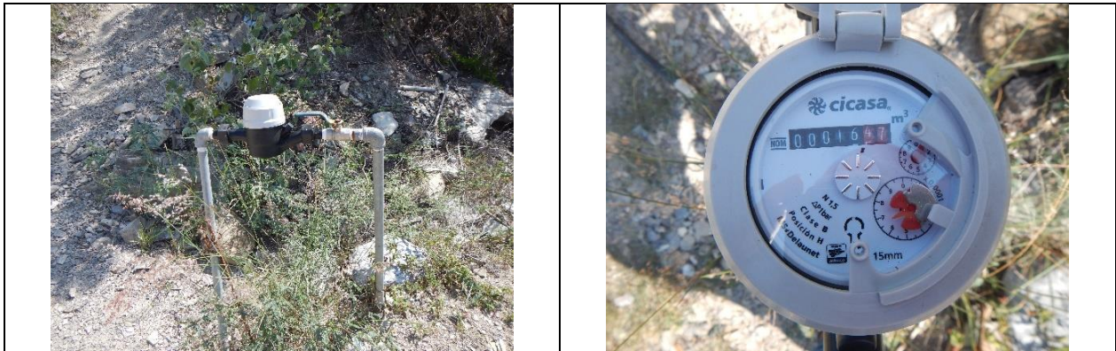
Figura 17. Medidor 16233542, clase B. Toma y detalle de carátula de medidor. Sin VAF. Localidad Peñamiller. Lectura del medidor: 16.47 m 3 .
