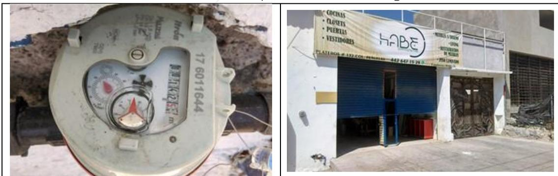
Figura 33. Medidor Itron, Multimag 176011644 clase C, sin VAF. Detalles de medidor con número de serie. Colonia San Pedrito Peñuelas, municipio de Querétaro. Lectura del medidor: 142.517 m<sup>3</sup>. El medidor no tiene la tapa. El medidor está instalado en una carpintería, sin embargo, no estaba el usuario y no supieron decir el tipo de usuario (doméstico o comercial).
