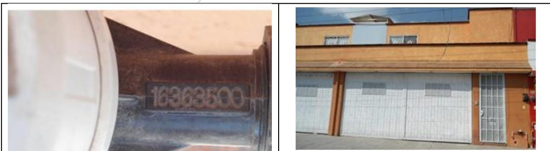
Figura 27. Medidor CICASA, MS Delaunet 16363500, clase B, con VAF2. Detalles de medidor con número de serie. Colonia Misión Fundadores, municipio de Querétaro. Lectura del medidor: 69.98 m<sup>3</sup>. El medidor no tiene grabado el número de serie en la tapa y la etiqueta que va en la misma ya no se ve, el número de serie está en los conectores.
