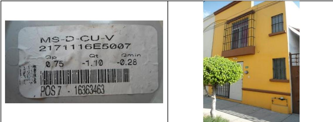
Figura 28. Medidor CICASA, MS Delaunet 16363463, clase B, con VAF2. Detalles de medidor con número de serie. Colonia Misión Fundadores, municipio de Querétaro. Lectura del medidor: 75.99 m<sup>3</sup>. El medidor no tiene grabado el número de serie en la tapa, pero si tiene etiqueta adherida a la tapa con el número de serie, además está también en los conectores.
