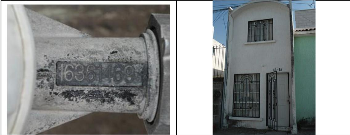
Figura 13. Medidor CICASA, MS Delaunet 16361469, clase B, **con VAF1**. Detalles de medidor con número de serie. Colonia Geoplazas, municipio de Querétaro. Lectura del medidor: 124.77 m<sup>3</sup>. El medidor no tiene grabado el número de serie en la tapa y la etiqueta que debe ir en la misma no está, el número de serie está en los conectores.
