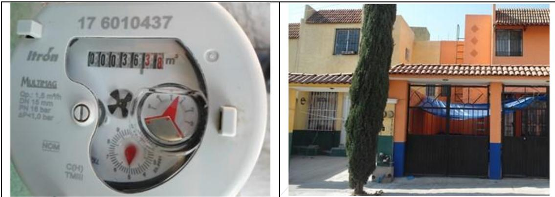
Figura 11. Medidor Itron, Multimag 176010437, clase C, sin VAF. Detalles de medidor con número de serie. Colonia Colinas del Poniente, municipio de Querétaro. Lectura del medidor: 36.38 m<sup>3</sup>.
