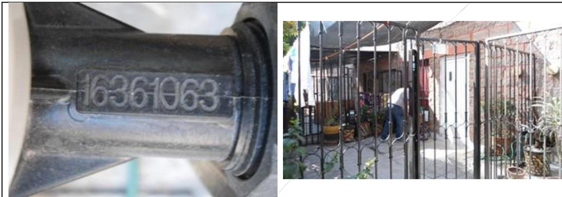
Figura 5. Medidor CICASA, MS Delaunet 16361063, clase B, **con VAF1**. Detalles de medidor con número de serie. Colonia Cerrito Colorado II, municipio de Querétaro. Lectura del medidor: 93.67 m<sup>3</sup>. El medidor no tiene grabado el número de serie en la tapa y la etiqueta que debe ir en la misma no está, el número de serie está en los conectores. El medidor está en el interior del domicilio.
