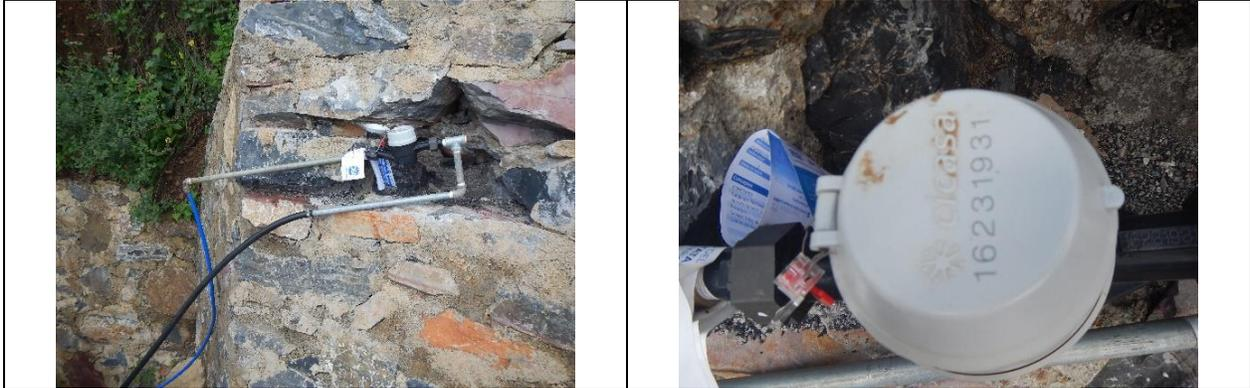
Figura 11. Medidor 16231931, clase B. Toma y detalle de medidor con número de serie. Sin VAF. Comunidad San Antonio. Lectura del medidor: 2.62 m<sup>3</sup>.
