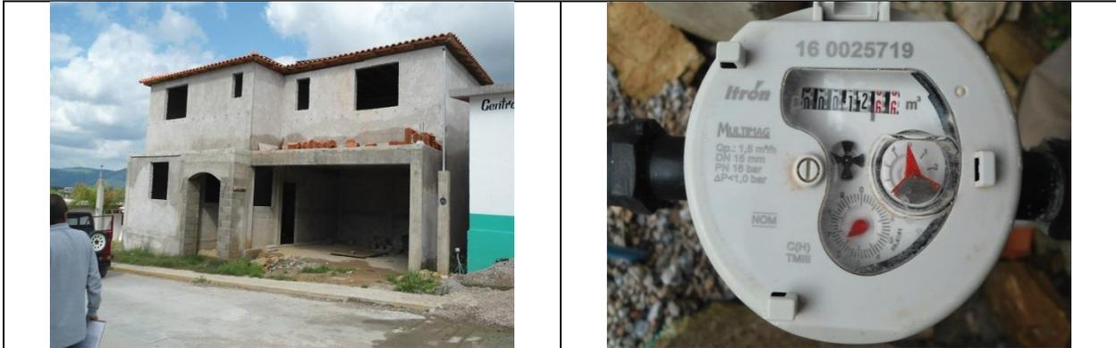
Figura 26. Medidor 160025719, clase C. Predio con toma y detalle de medidor con número de serie. Sin VAF. Comunidad Apartadero. Lectura del medidor: 12.66 m<sup>3</sup>.
