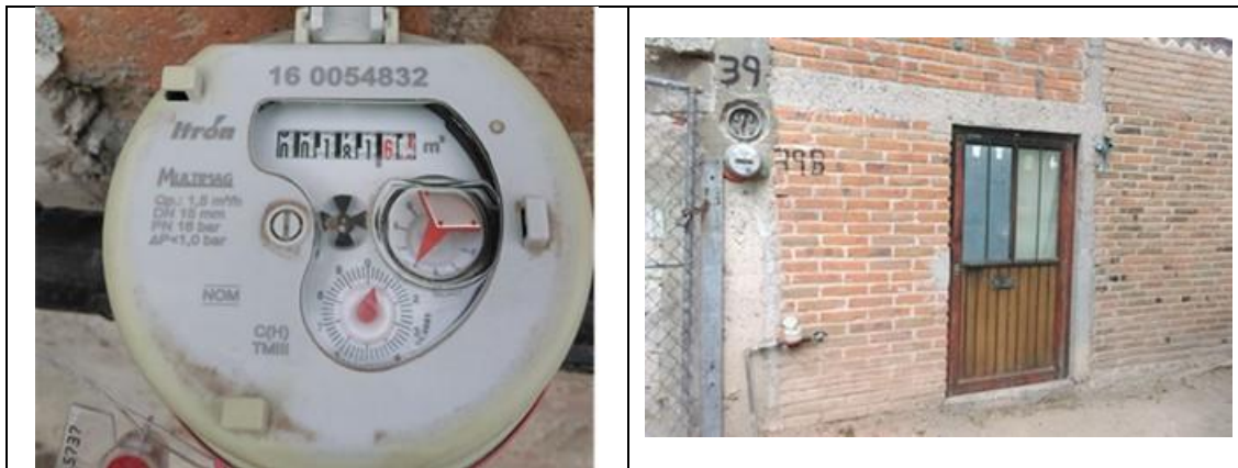
Figura 1. Medidor Itrón, Multimag 160054832 clase C, sin VAF. Detalles de medidor con número de serie. Barrio La Magdalena, municipio de Tequisquiapan. Lectura del medidor: 181.616 m 3 . El domicilio tiene pintado el número 39 y en la base de datos dice S/N.
