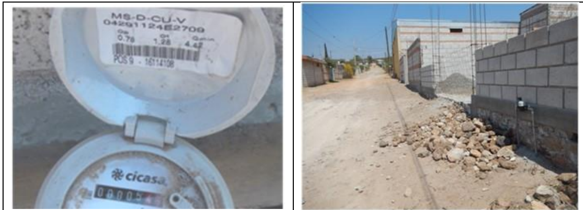
Figura 25. Medidor CICASA, MS Delaunet 16114108, clase B, con VAF. Detalles de medidor con número de serie. Comunidad La Fuente, municipio de Tequisquiapan. Lectura del medidor: 5.47 m 3 . El Predio está en construcción.
