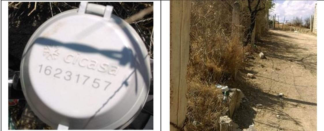
Figura 13. Medidor CICASA, MS Delaunet 16231757, clase B, sin VAF. Detalles de medidor con número de serie. Comunidad Horno de Cal, municipio de Tolimán. Lectura del medidor: 76.593 m<sup>3</sup>. El pago está domiciliado.
