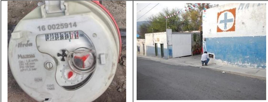
Figura 7. Medidor Itron, Multimag 160025914, clase C, sin VAF. Detalles de medidor con número de serie. Colonia Cerrito San José, municipio de Tolimán. Lectura del medidor: 1389.721 m<sup>3</sup>.
