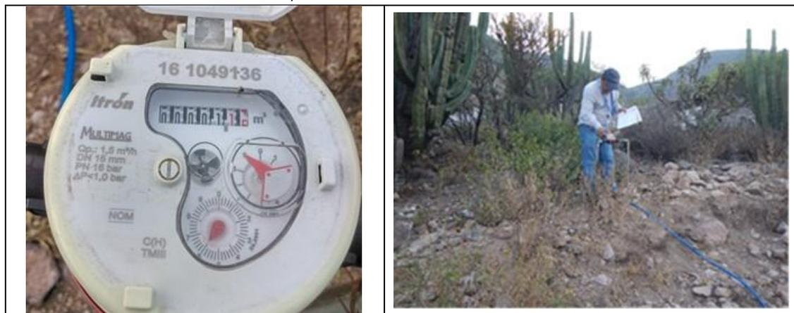
Figura 17. Medidor Itron, Multimag 161049136, clase C, sin VAF. Detalles de medidor con número de serie. Comunidad Panales, municipio de Tolimán. Lectura del medidor: 1.149 m<sup>3</sup>. El medidor no tiene murete. El predio está en construcción.
