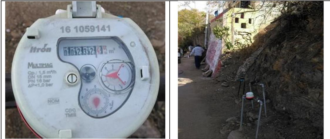
Figura 4. Medidor Itron, Multimag 161059141, clase C, sin VAF. Detalles de medidor con número de serie. Comunidad Casas Viejas, municipio de Tolimán. Lectura del medidor: 232.389 m<sup>3</sup>.
