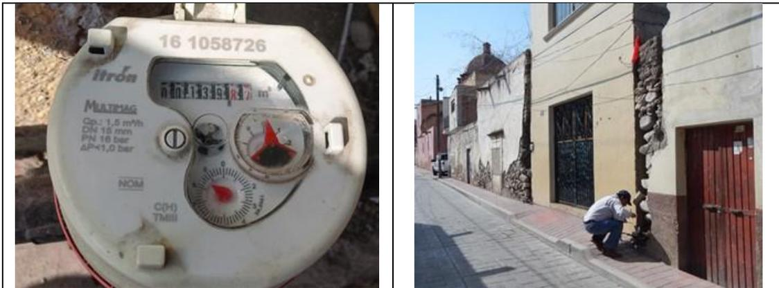
Figura 29. Medidor Itrón, Multimag 161058726, clase C, con VAF2. Detalles de medidor con número de serie. Tolimán, municipio de Tolimán. Lectura del medidor: 139.87 m<sup>3</sup>.
