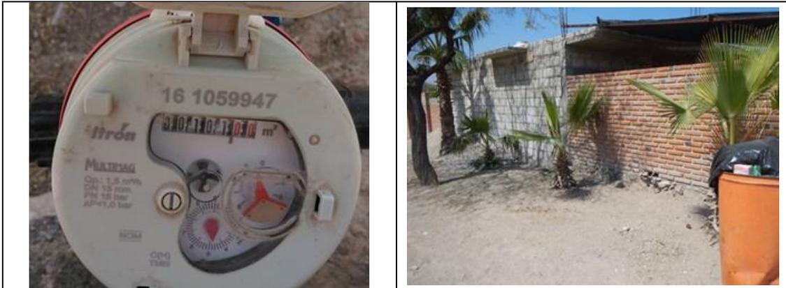
Figura 22. Medidor Itron, Multimag 161059947, clase C, sin VAF. Detalles de medidor con número de serie. Comunidad San Pablo, municipio de Tolimán. Lectura del medidor: 101.001 m<sup>3</sup>.
