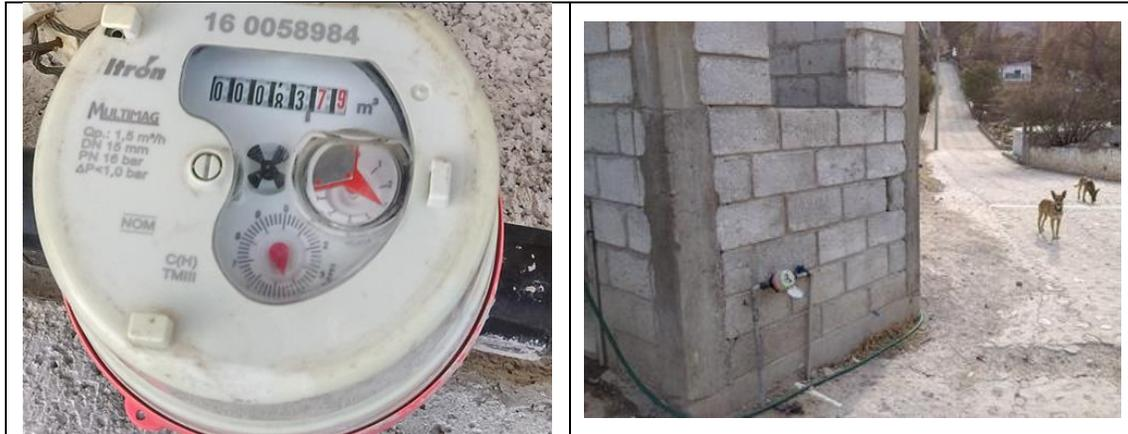
Figura 19. Medidor Itron, Multimag 160058984, clase C, **con VAF1**. Detalles de medidor con número de serie. Comunidad Sabino de San Ambrosio, municipio de Tolimán. Lectura del medidor: 83.794 m<sup>3</sup>. Lote en construcción.
