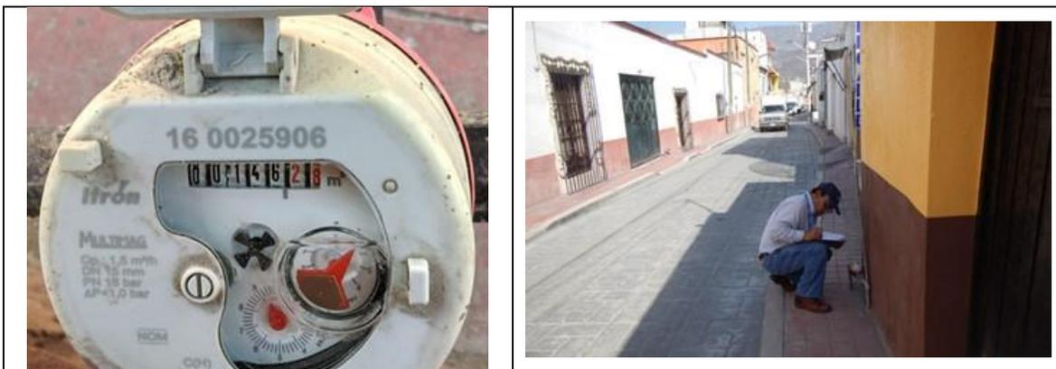
Figura 30. Medidor Itrón, Multimag 160025906 clase C, con VAF2. Detalles de medidor con número de serie. Tolimán, municipio de Tolimán. Lectura del medidor: 146.681 m<sup>3</sup>.
