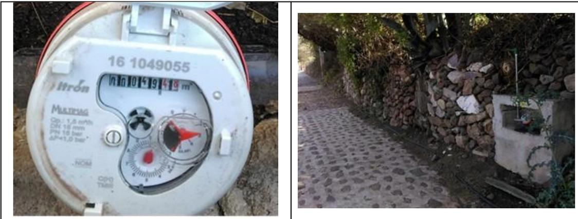
Figura 2. Medidor Itron, Multimag 161049055, clase C, sin VAF. Detalles de medidor con número de serie. Comunidad Bomintza, municipio de Tolimán. Lectura del medidor: 49.482 m<sup>3</sup>.
