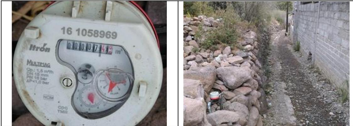
Figura 1. Medidor Itron, Multimag 161058969 clase C, sin VAF. Detalles de medidor con número de serie. Comunidad Barrio de García, municipio de Tolimán. Lectura del medidor: 7.485 m<sup>3</sup>. **El medidor no tiene tapa.**
