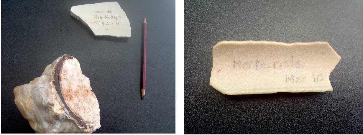
Ilustración 4.34 Cristales que obstruían las tuberías y ocasionaban problemas de baja presión.
