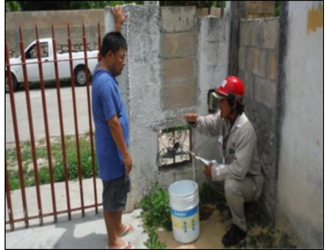
Ilustración 4.70 Verificación del medidor domiciliario de forma volumétrica
