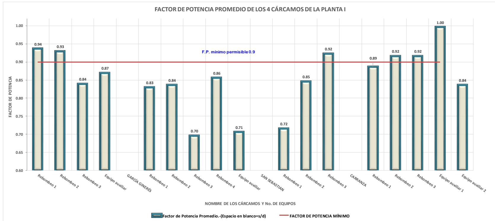
Gráfica 4.12 Factor de Potencia de los equipos de bombeo correspondientes a los Cárcamos de la planta potabilizadora 1
