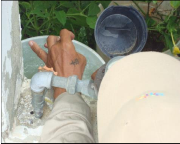
Ilustración 4.70 Verificación del medidor domiciliario de forma volumétrica
