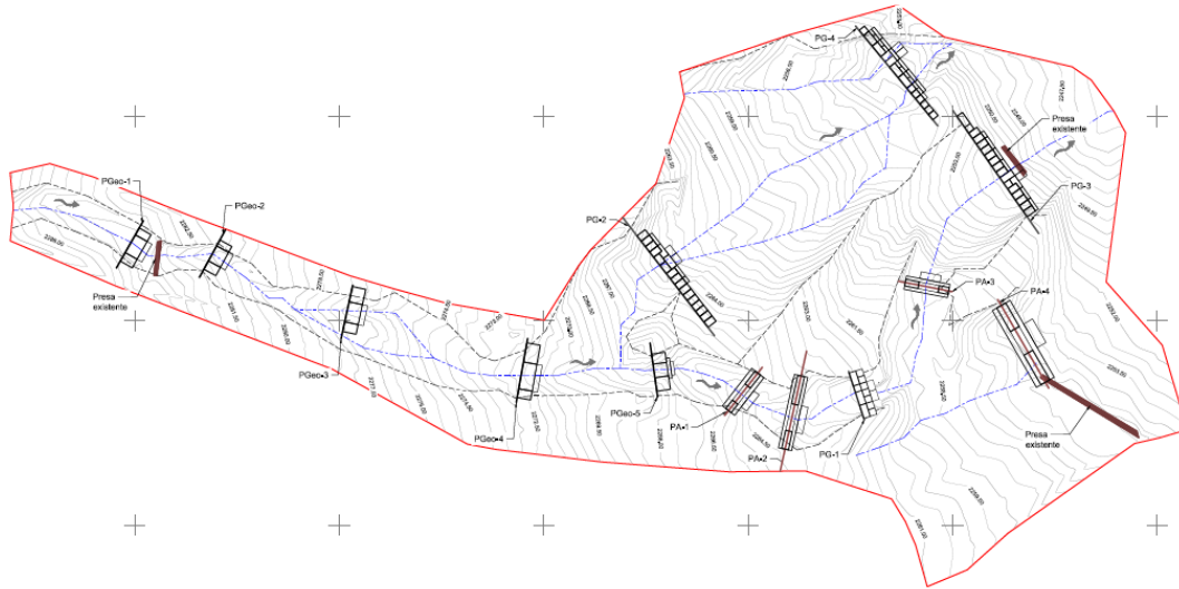
Figura 57. Plano topográfico con la ubicación de las secciones de cada una de las presas que se construyeron en la microcuenca del Cerro Tariaqueri.
