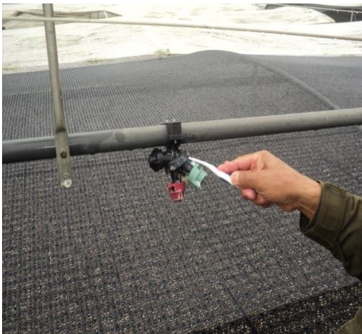
Limpieza y ajuste de boquillas aspersoras del robot-regador.
