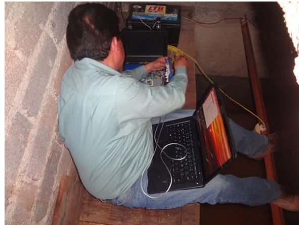
Figura 64. Mantenimiento de los equipos de medición de gasto con sensores ultrasónicos con telemetría en las microcuencas pareadas.
