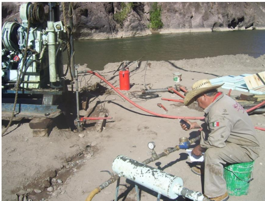
Figura 4-2. Ensayes de Permeabilidad Tipo Lugeón en el macizo rocoso sobre el Eje Longitudinal de la Cortina para conocer las características Permeables del Conglomerado Baucarit que se tiene en la zona del cauce del Río Mayo. Fuente: Proyecto Ejecutivo de la Presa Reguladora Pilares, sobre el Río Mayo, Mpio. Álamos, Estado de Sonora. Capítulo IV. Geología.
