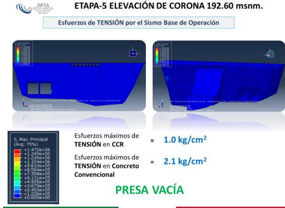
Figura 4-49. Respuesta máxima de la cortina para el sismo correspondiente al nivel base de operación cuando la cortina se encuentra construida hasta el nivel 192.60 msnm.
