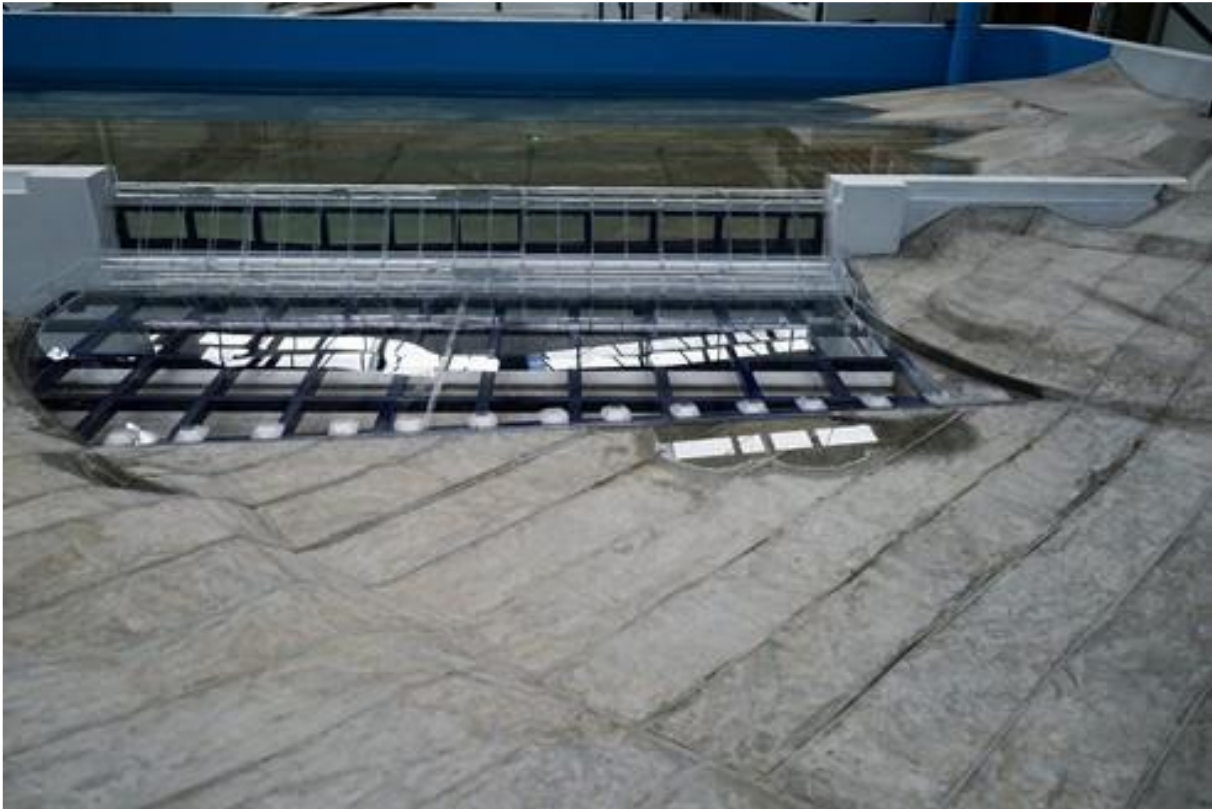
Figura 2-16. Vista del modelo físico del vertedor con diseño original
