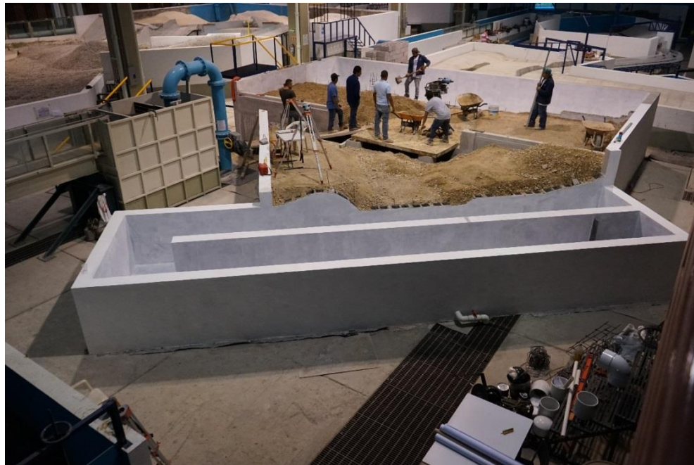
Figura 2-14. Preparación y colocación del material de relleno
