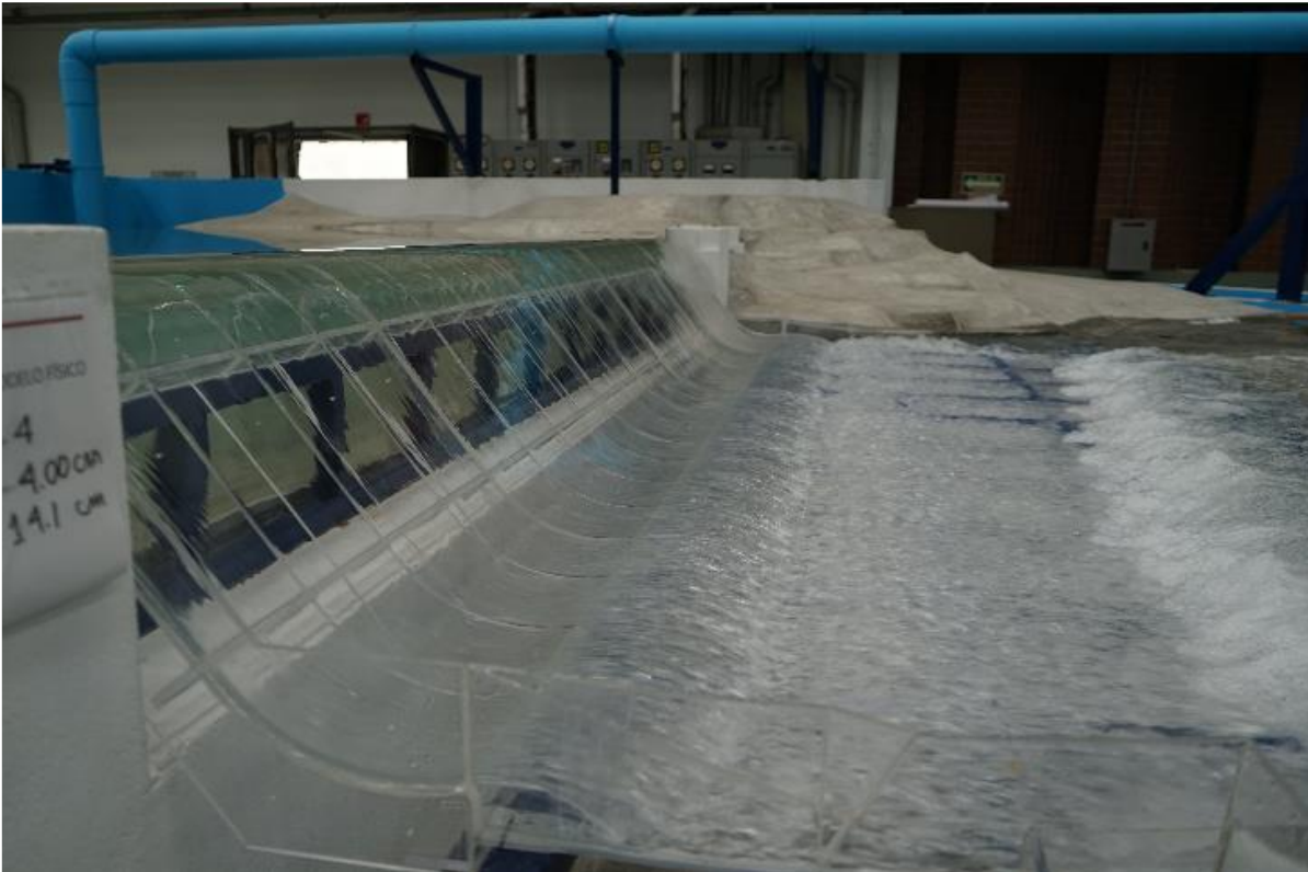
Figura 2-17. Vista lateral del funcionamiento del vertedor para una carga sobre la cresta de 2.8 m (Según prototipo)
