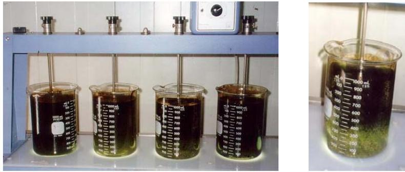
**Figura 1: Pruebas en jaras para determinación de dosis de los reactivos químicos para la separación del aceite emulsificado.**
